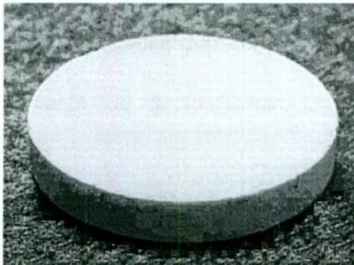
Figura 6. Probetas en forma de pastilla de 1.3 cm de diámetro y espesor de .5 cm.
