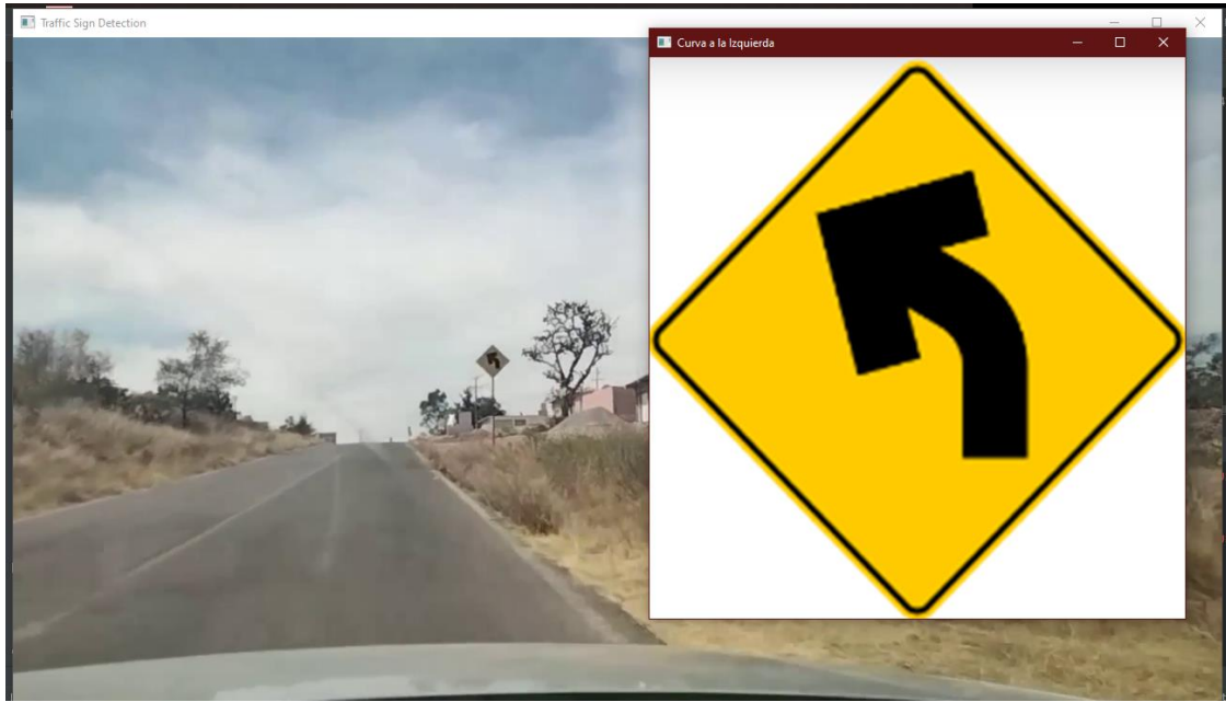
Figura 48.- Detección y reconocimiento de una señal de curva a la izquierda a una velocidad de desplazamiento de 40 km/h.
