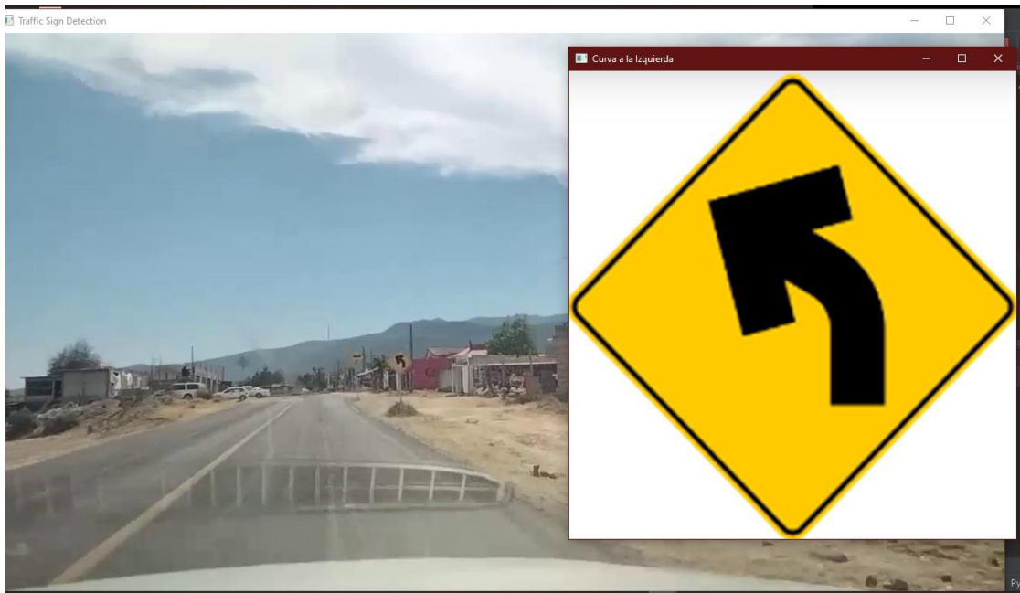
Figura 51.- Detección y reconocimiento de una señal de curva a la izquierda a una velocidad de desplazamiento de 100 km/h.
