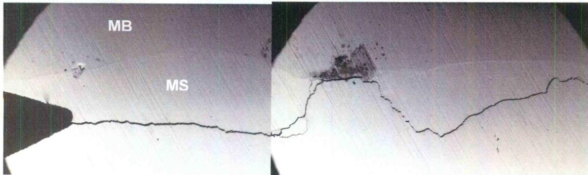
Figura 40. Imagen lateral del espécimen 3 donde se observa el inicio del crecimiento de grieta en fatiga (parte izquierda). También se observa que el inicio y crecimiento de esta fisura fue en el metal de soldadura.
