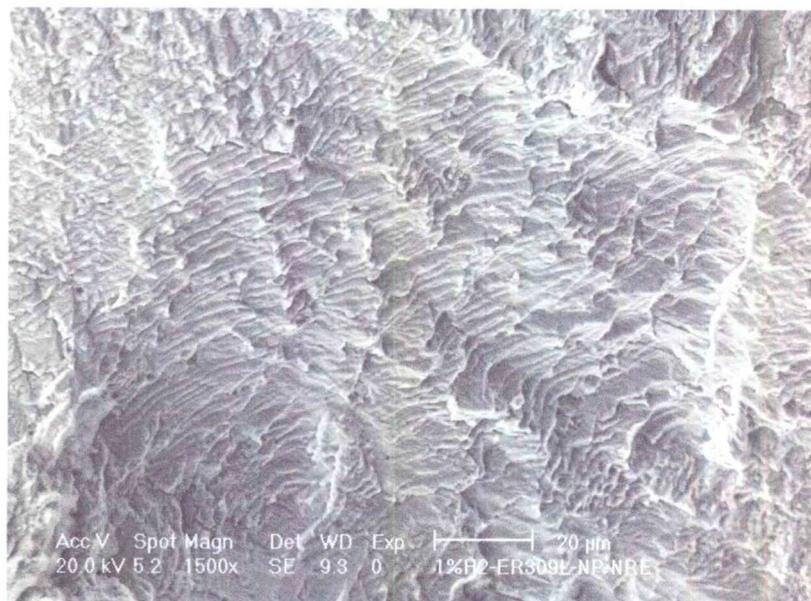
Figura 41. Fractografía de fatiga en el espécimen 3.
