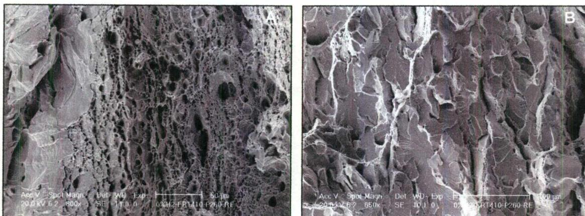
Figura 54. Característica de propagación de la fractura en la prueba de tenacidad a la fisuración A) Secciones que muestran un aspecto dúctil (coalescencia de microcavidades) y B) secciones totalmente frágiles (clivaje).
