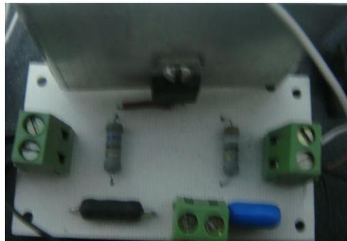
Figura 3.14 Tarjeta para el circuito de potencia
