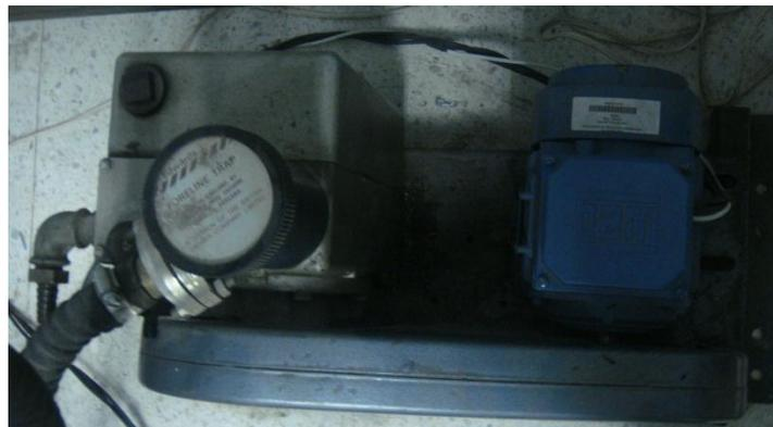
Figura 3.16 Bomba de vacío.
