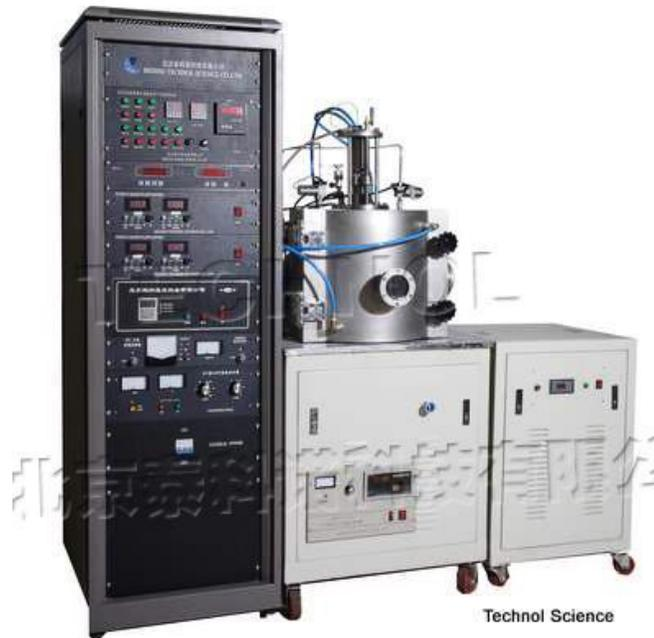
Figura 1.2 Equipo de la empresa Technol Science modelo PECVD-450.
