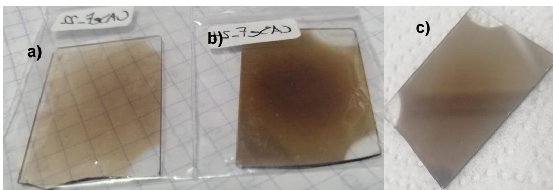
Figura 25. Depósitos a) CF_22, b) CF_24 y c) CF_25 de películas de \text{CuSbSe}_2 con una potencia del láser al 60% y en rotación del sustrato.
