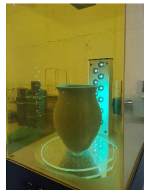
Figura 6. Proceso de impresión en 3D de la vasija. Archivo personal
