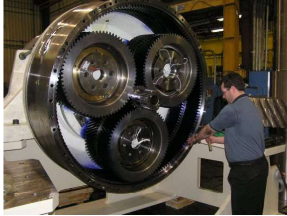
Figura 4.17: Transmisión epicycloidal o de ejes planetarios [12].
