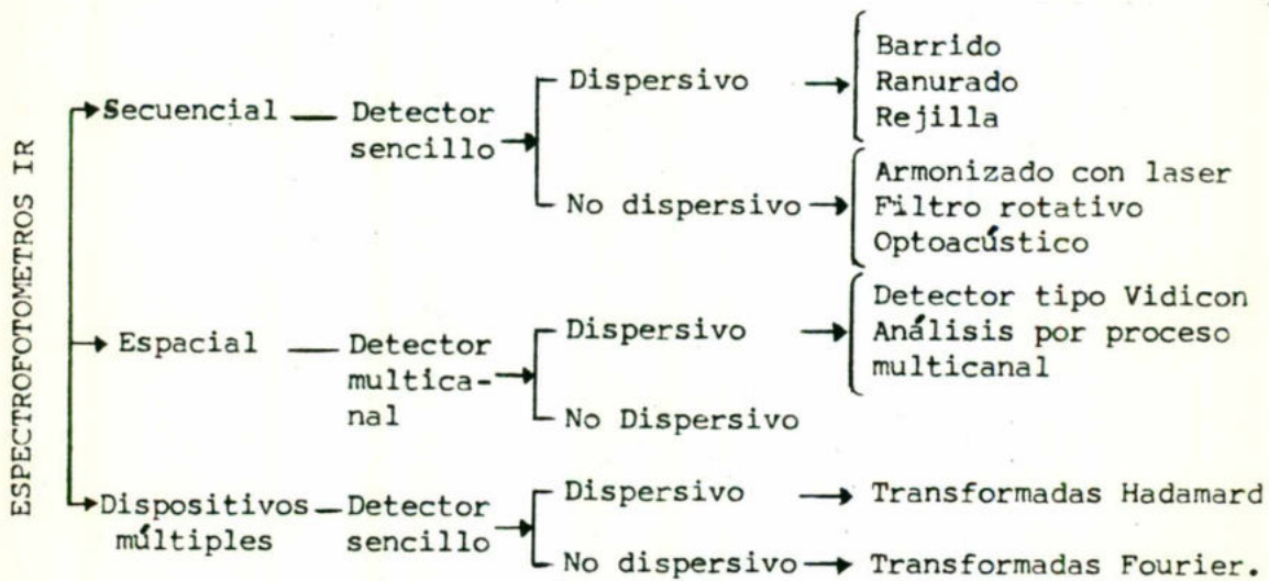
Fig. 2.1. (XII, Cap.2, Pag.9). Clasificación de los espectrofotómetros IR.
