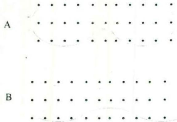
Figura 32. (A) Onda de Lamb simétrica o de dilatación, y (B) Onda de Lamb asimétrica o de flexión
