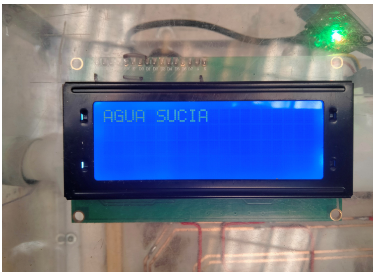
Figura 4.4: Texto en Pantalla LCD mostrado al haber agua sucia
