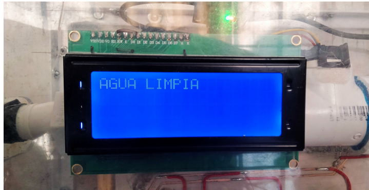
Figura 4.6: Texto en Pantalla LCD mostrado al haber agua limpia
