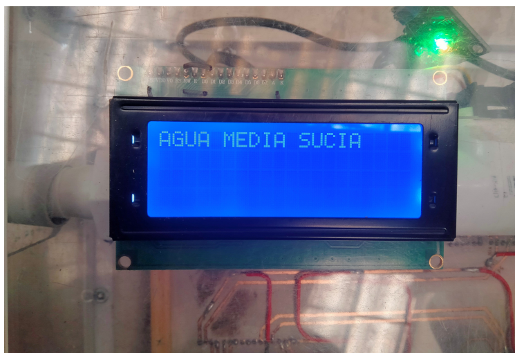
Figura 4.5: Texto en Pantalla LCD mostrado al haber agua media sucia
