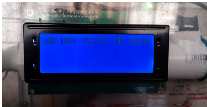
Figura 4.7: Texto en Pantalla LCD mostrado al no haber flujo de agua
