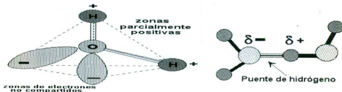
Figura 2.4.- Formación del puente de hidrogeno en la Molécula de Agua
