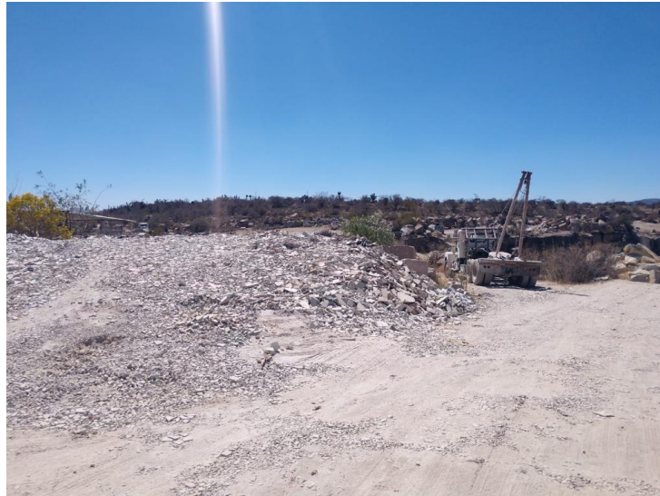
Figura 7. Muestreo del material de acuerdo con la norma ASTM-D75
