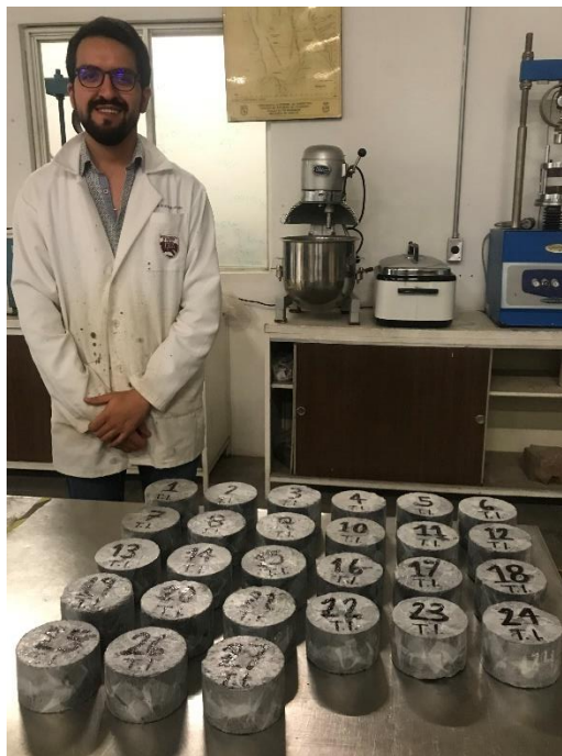
Figura 22. Pastillas para tensión indirecta envueltas en Parafilm
