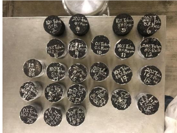
Figura 19. Pastillas generadas para prueba de resistencia a la tensión indirecta (IDT)
