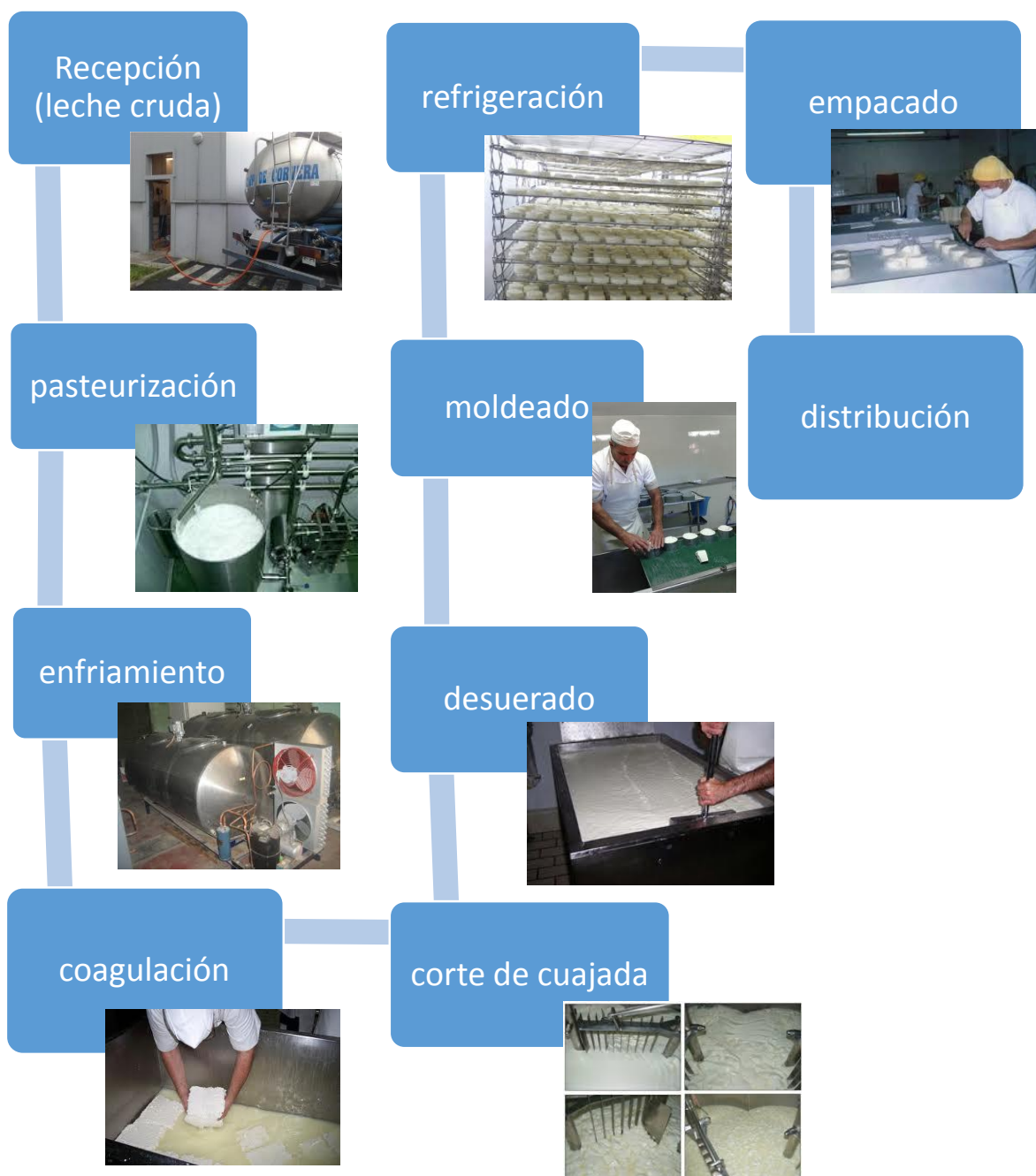
Figura 3. Diagrama general del proceso de producción del queso fresco.
