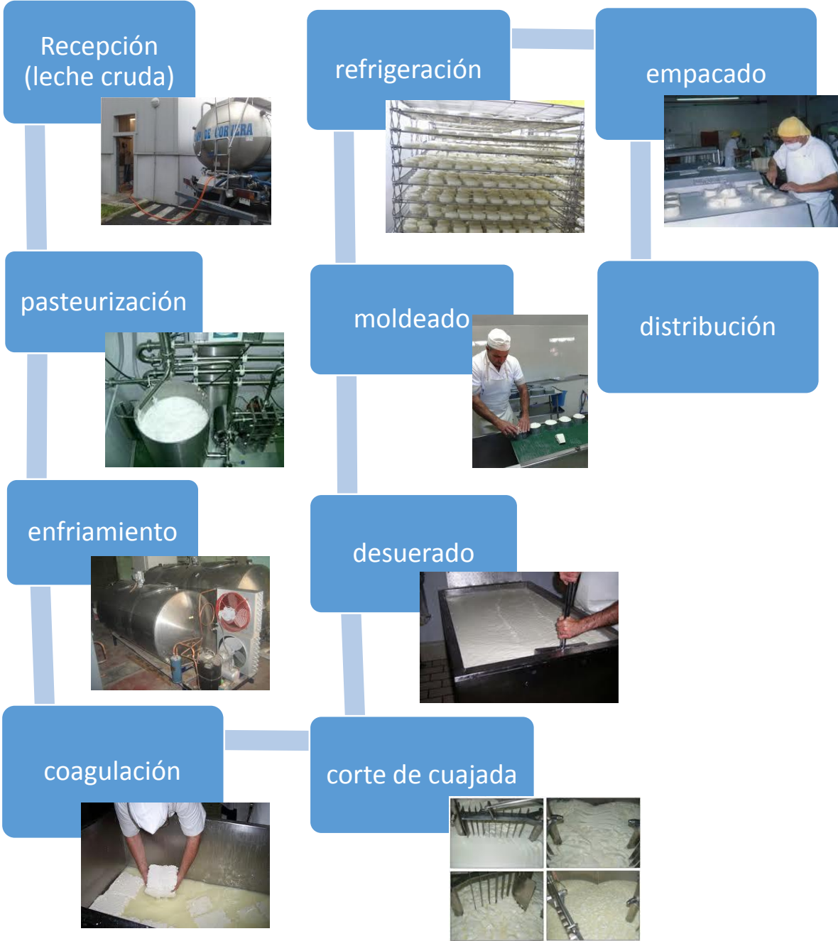
Figura 3. Diagrama general del proceso de producción del queso fresco.
