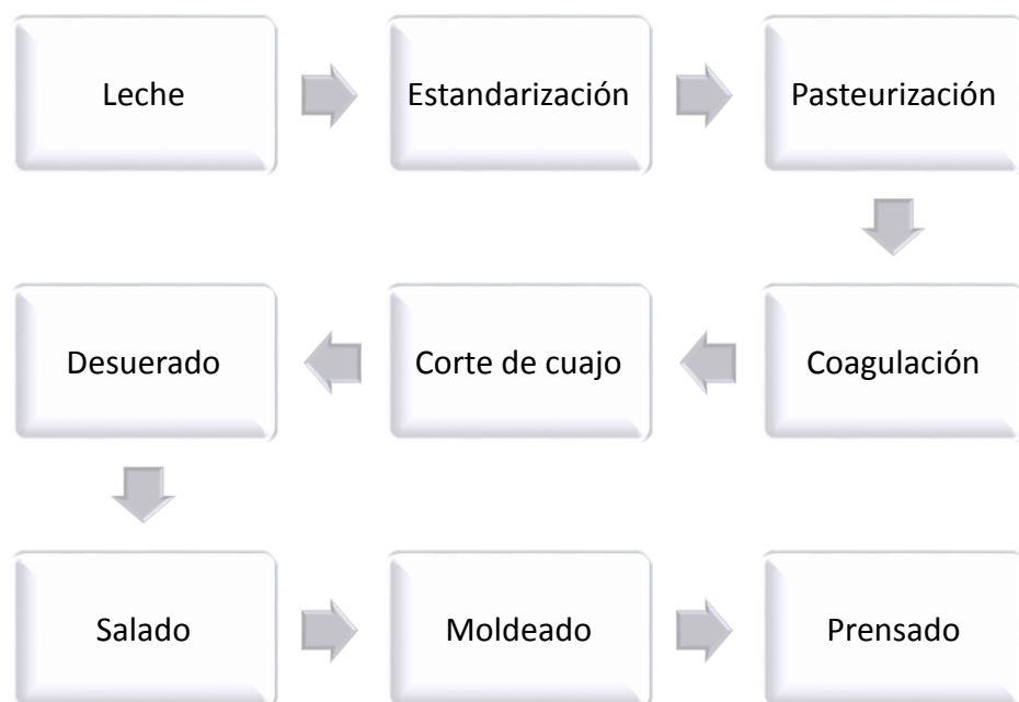
Figura 2.7 Diagrama de flujo de los principales pasos para la elaboración de queso (Fox y Cogan, 2000)
