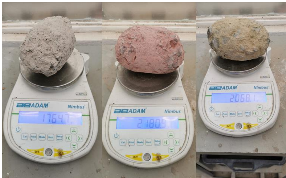
Figura 17. Masa de núcleos de cilindro una vez terminada la prueba de desgaste de los Ángelesx
