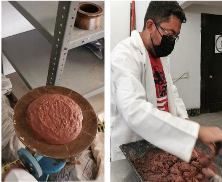
Figura 4. Prueba de fluidez en un mortero de color rojo
