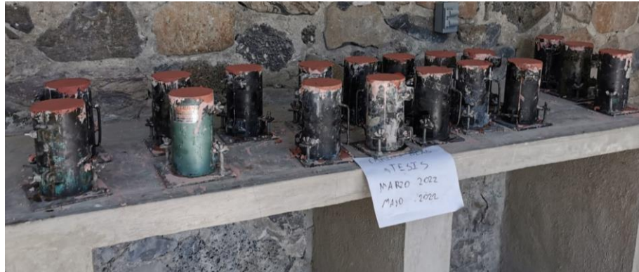
Figura 12. Elaboración de especímenes cilíndricos de la mezcla pigmentada de color rojo 6%
