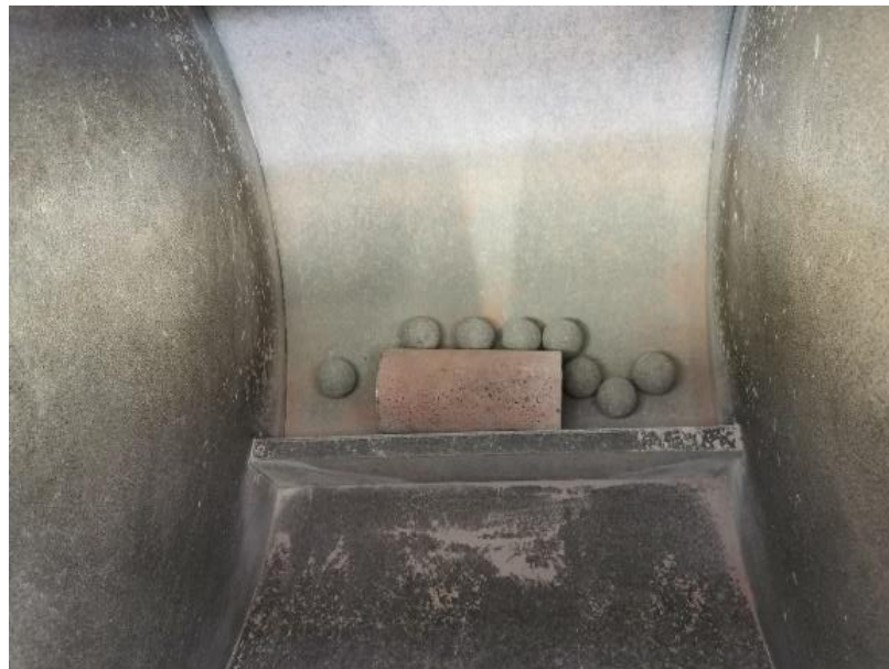
Figura 15. Prueba de desgaste de los Ángeles antes de dar las revoluciones, con el cilindro y la carga abrasiva
