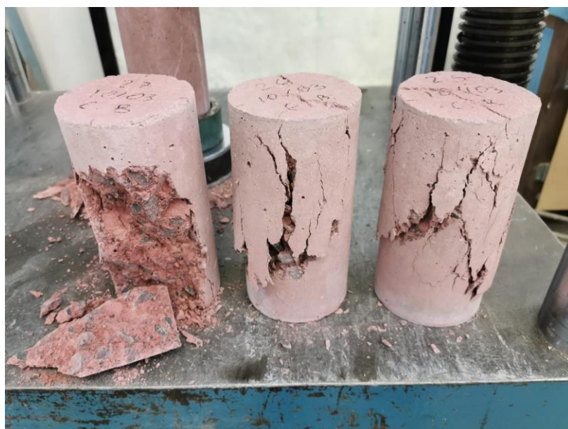
Figura 25. Resistencia a la compresión en cilindros afectados por cambios de temperatura
