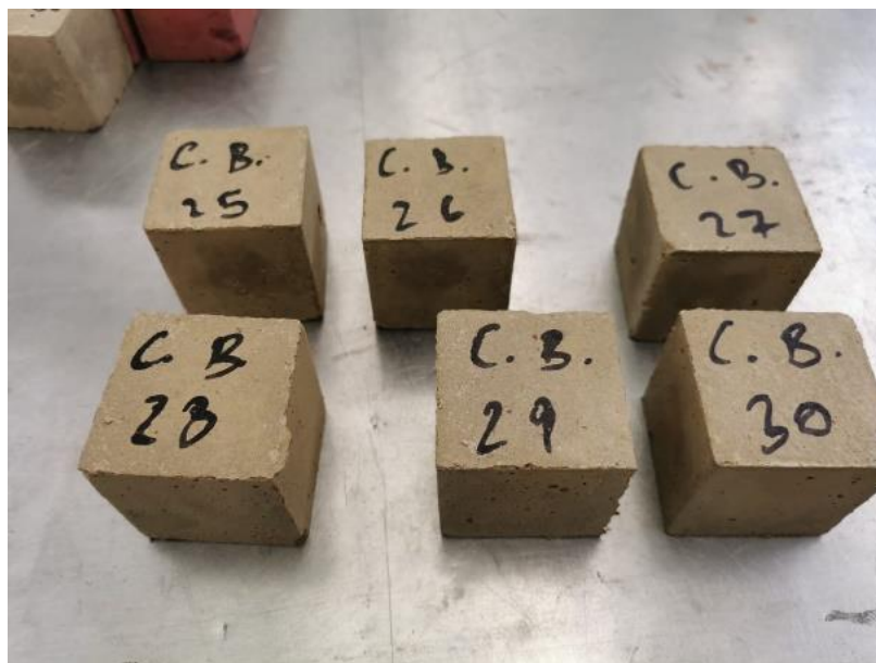
Figura 32. Coloración de mezcla de mortero con 10% de pigmento amarillo
