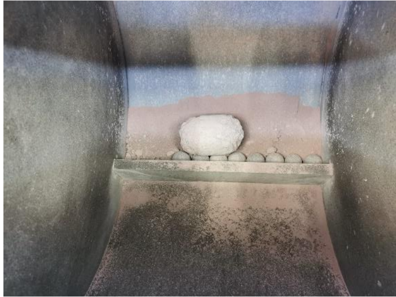
Figura 16. Prueba de desgaste de los Ángeles una vez que finalizan las revoluciones
