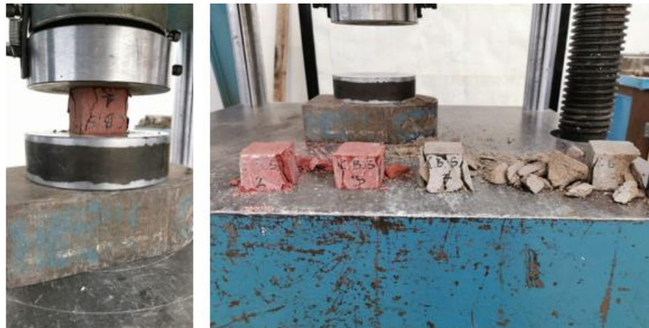
Figura 7. Ensayo de resistencia a la compresión en especímenes cúbicos
