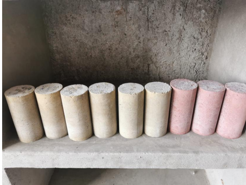
Figura 20. Ciclado de secado de los cilindros
