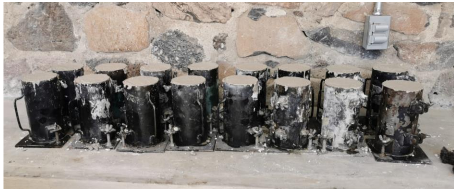
Figura 11. Elaboración de especímenes cilíndricos de la mezcla base
