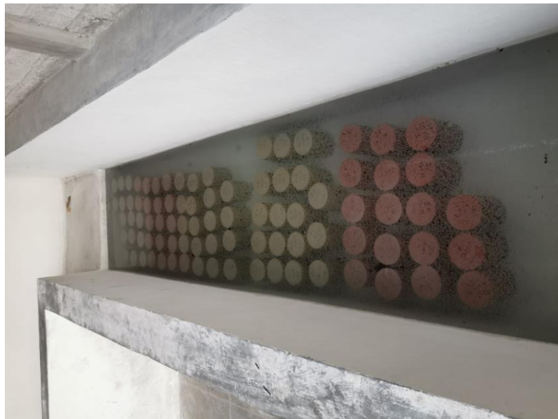
Figura 13. Proceso de curado de los cilindros en un tanque con agua
