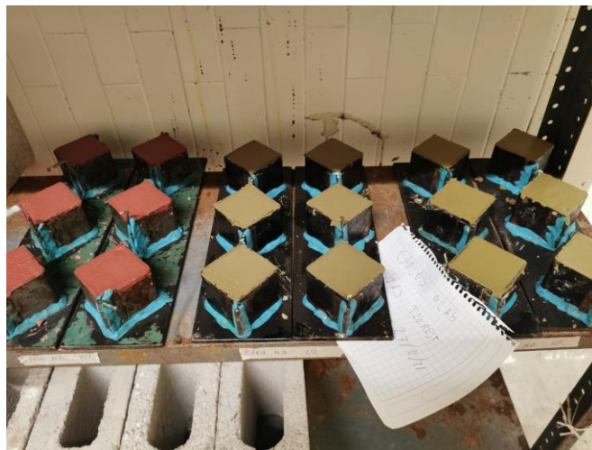
Figura 5. Moldeado de especímenes cúbicos de mortero de 5 x 5 x 5 cm
