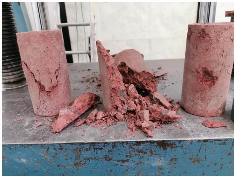
Figura 21. Ensaye de resistencia a la compresión en cilindros afectados por los efectos del cloruro de sodio
