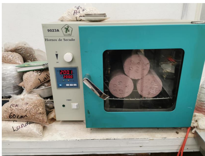
Figura 23. Temperatura final a la que se sometieron los cilindros de concreto (200°C)
