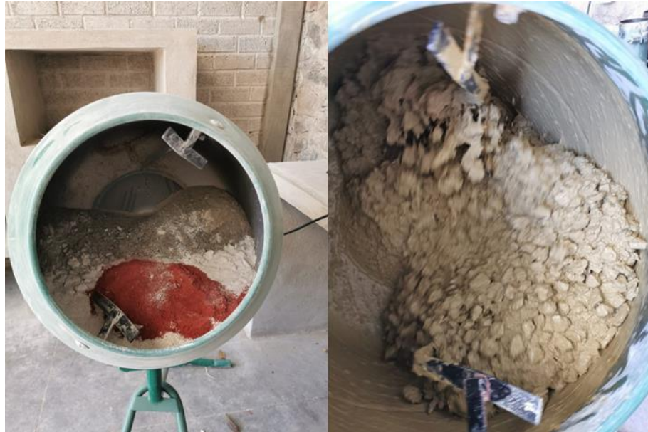
Figura 8. Mezclado de materiales en revolvedora eléctrica
