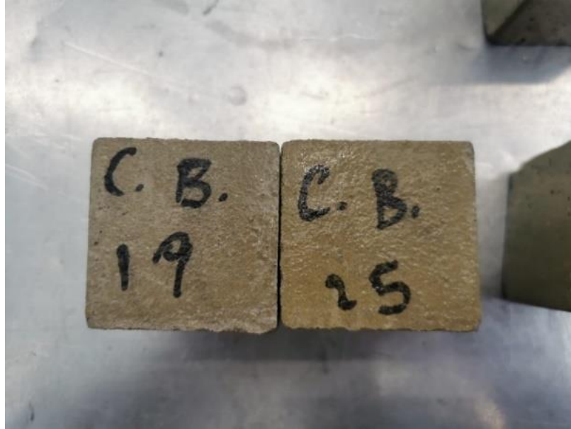
Figura 33. Diferencia entre coloración de mezclas de mortero amarillas con 6 y 10% de pigmento respectivamente
