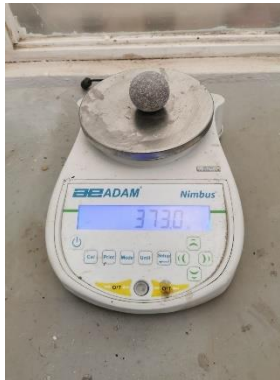
Figura 14. Esfera de acero empleada en la prueba de desgaste de los Ángeles
