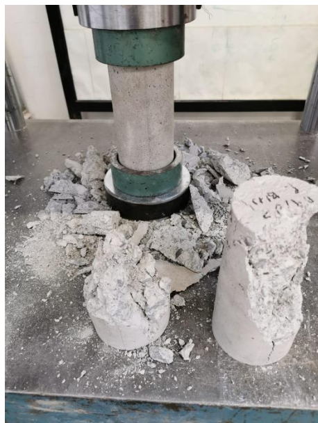
Figura 27. Resistencia a la compresión en mezcla base
