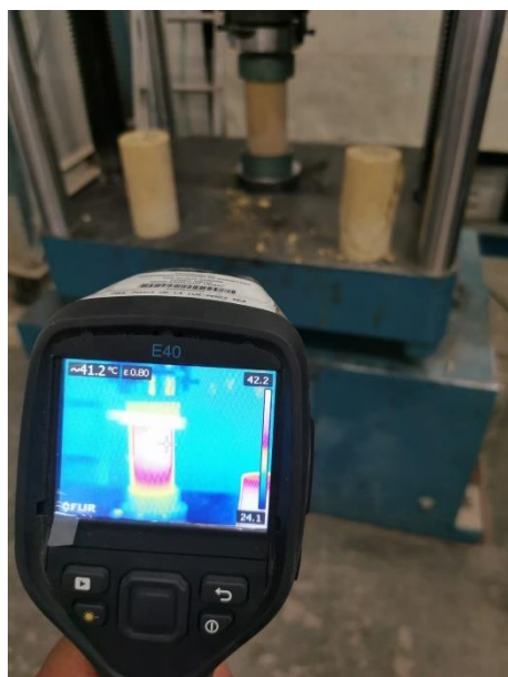
Figura 24. Medición de temperatura del cilindro al momento de ser ensayado a resistencia a la compresión
