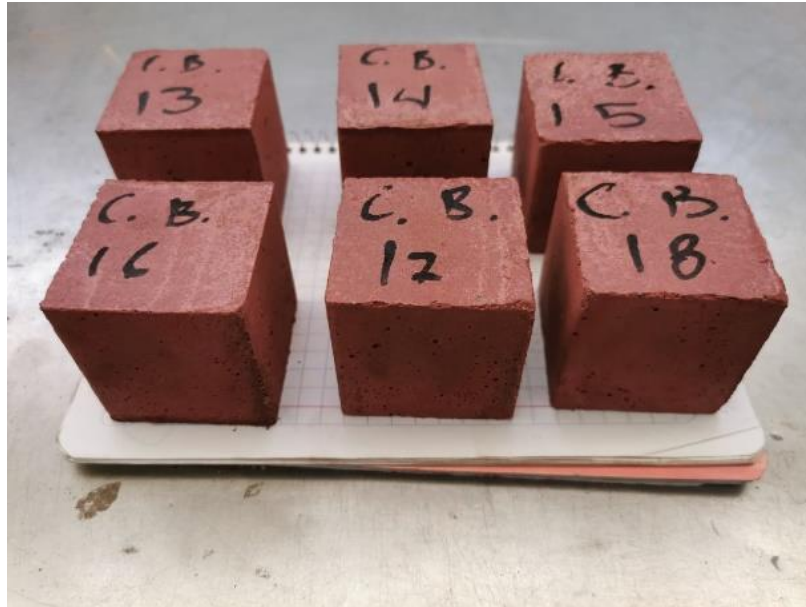
Figura 31. Coloración de mezcla de mortero con 10% de pigmento rojo
