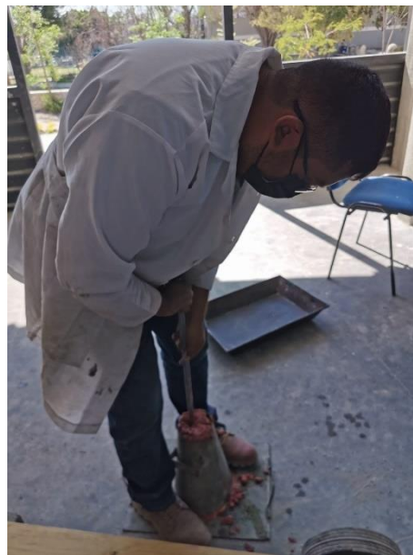
Figura 9. Prueba de revenimiento en la mezcla de concreto
