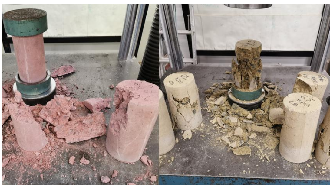
Figura 28. Resistencia a la compresión en mezclas pigmentadas de color rojo y amarillas
