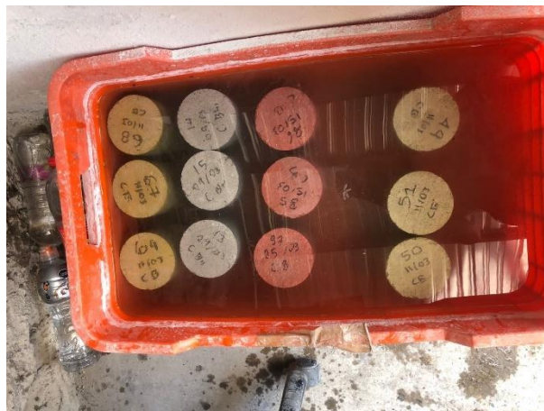
Figura 19. Ciclado de humedecimiento en la solución de cloruro de sodio con agua
