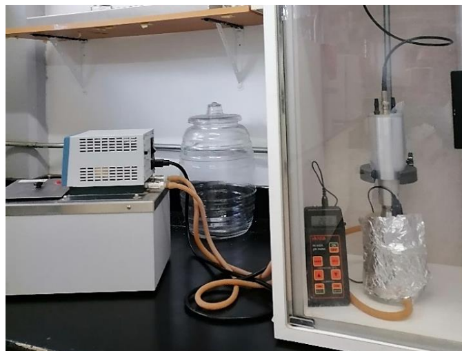
Figura 5. Equipo de Extracción Asistida por Ultrasonido de compuestos fenólicos en cáscara de granda.
