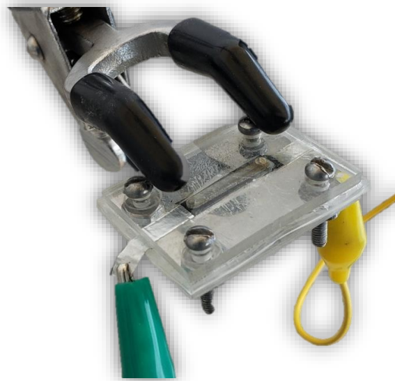
Fig. 13: Armado correcto de la ZAB
