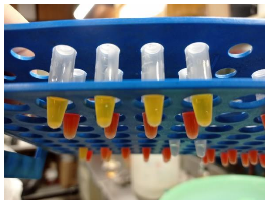
Figura 13 Resultados de la prueba carba NP. De izquierda a derecha corresponde a C (+), K-200, K- 211 y K-241. Cada muestra tiene su blanco de reacción en la parte posterior.
