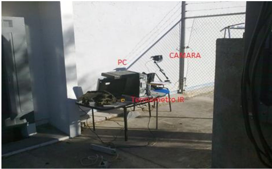
Figura 13. Equipo utilizado para la medición de la prueba
