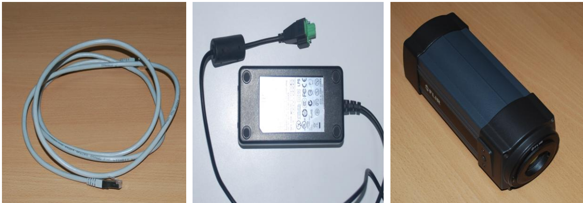
Figura 57. Componentes principales para el uso de la cámara, A) cable Ethernet B) regulador, C) cámara termográfica.
