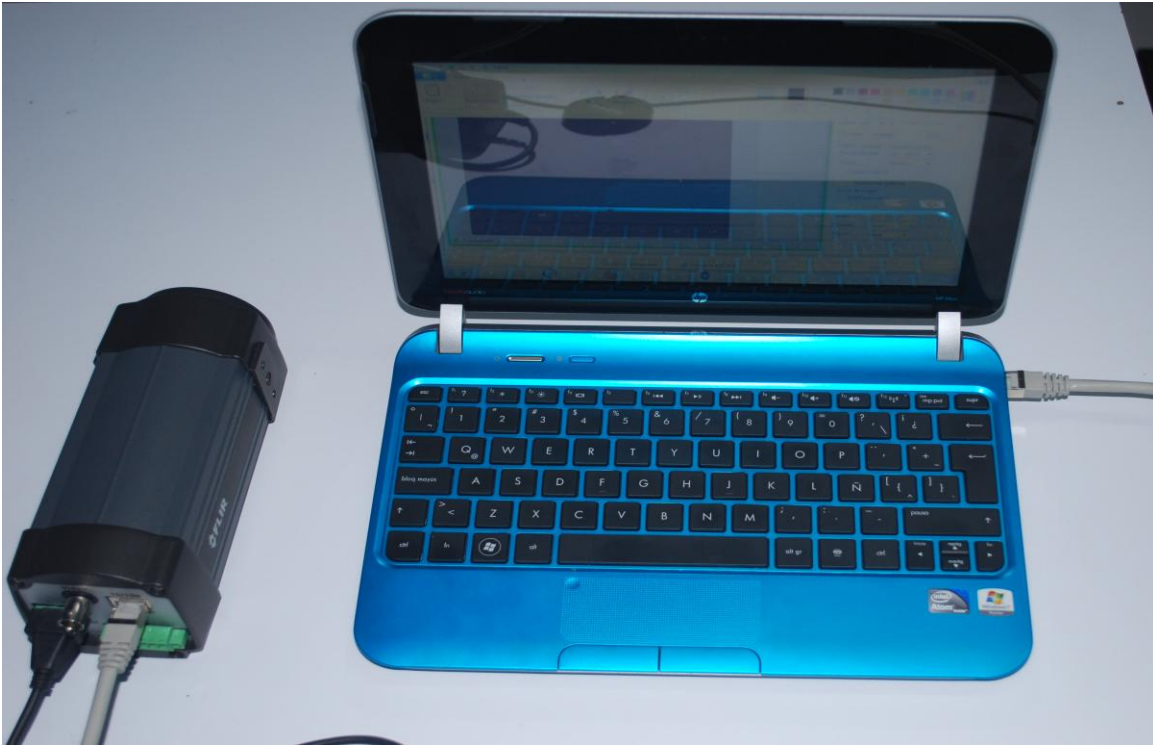
Figura 59. Equipo de la cámara termográfica conectado a la laptop.
