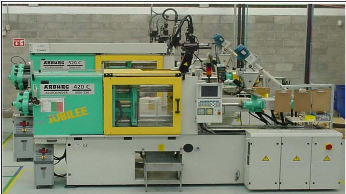
Figura 2.3. Máquina de inyección de plástico de modelo reciente marca Arburg, de origen Alemán.
