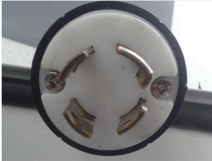
**Figura 4.6.** Clavija trifásica de seguridad.
