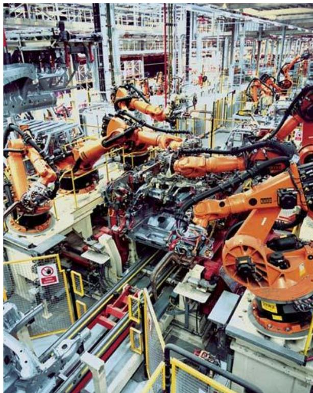
**Figura 1.1.** Robots industriales realizando una tarea automática en una línea de ensamblaje.
