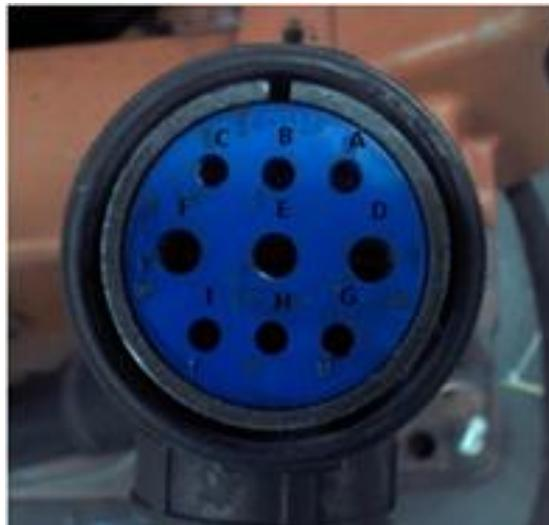
**Figura 2.14.** Conector hembra de cable de control para servomotores M1, M2 y M3.
