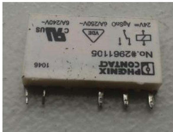
**Figura 4.4.** Relevador de control de frenos electromecánicos.
