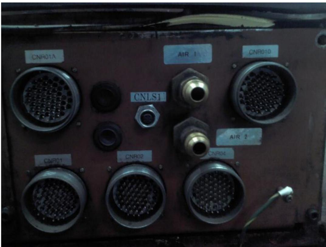
**Figura 2.11.** Conectores macho de salida para cable de control.
