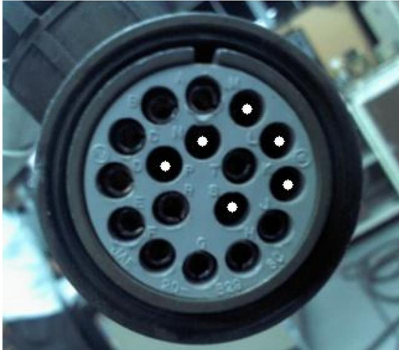
**Figura 2.16.** Pines utilizados en el conector de encoder.
