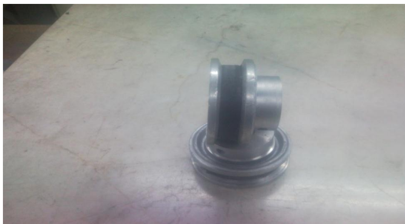
Figura 3-10: Poleas de transmisión con recubrimiento.
