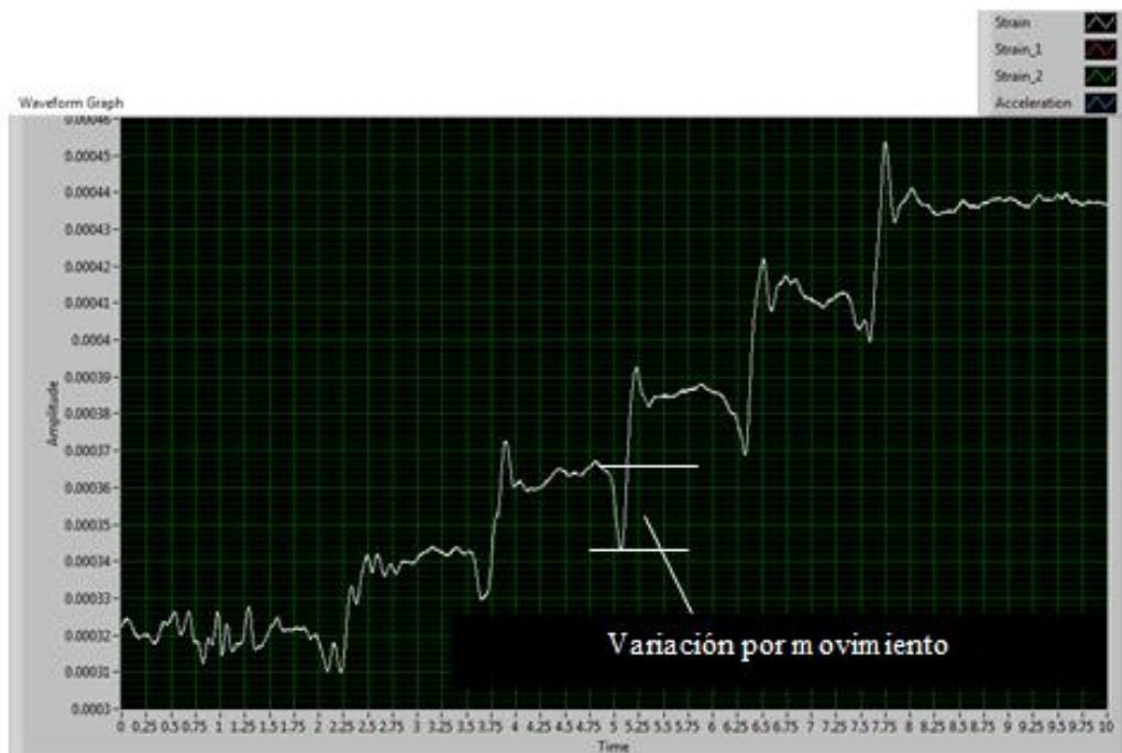
Figura 3-13: Variaciones de la deformación unitaria en la banda, prueba libre #1 a 25Kg
