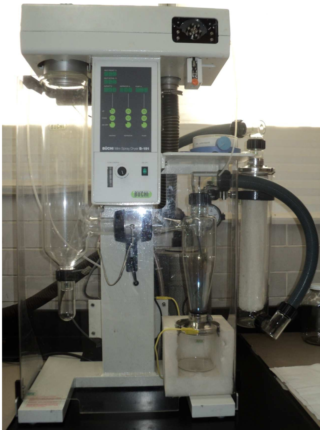
Figura 17. Secador por aspersion Büchi mini spray dryer B-191.
