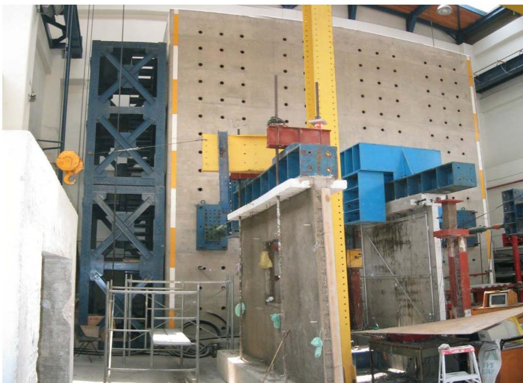
*Figura 2.7.- Muro de reacción del CENAPRED.*
