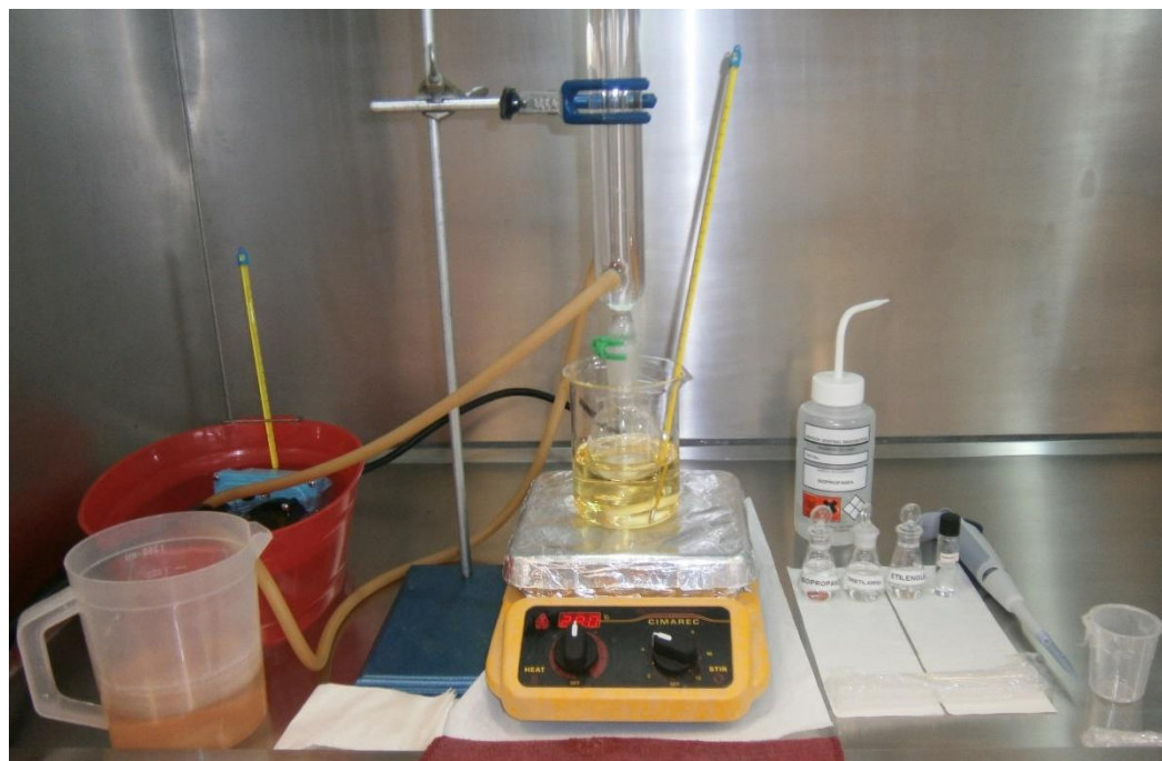
Figura 14. Sistema para síntesis de ZnO.
