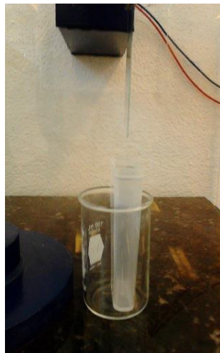
Figura 17. Sustrato para ser sumergido en la solución sol-gel.
