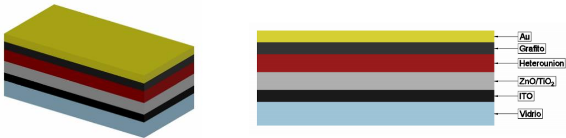
Figura 18. Dispositivo fotovoltaico a desarrollar.
