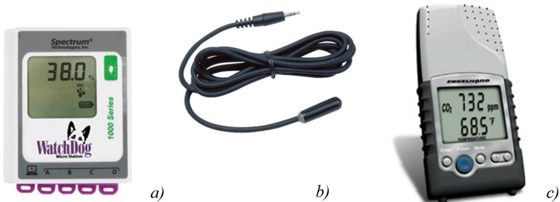
Figura 5.3 Sensores a utilizar. a) datalogger watchdog serie 1000, b) sensor de temperatura, c) monitor de CO 2 .
