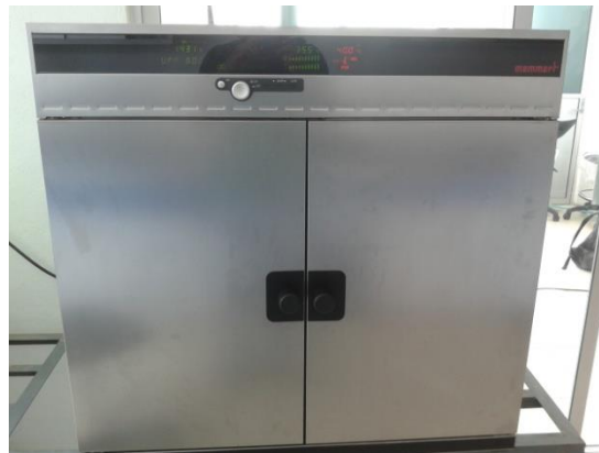
Figura 6.1 Estufa de temperatura controlada, ubicada en el laboratorio de peces del campus Amazcala.
