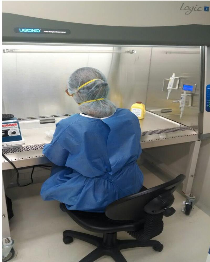
Figura 25. Extracción manual en campana de bioseguridad clase II-A LABCONCO.
