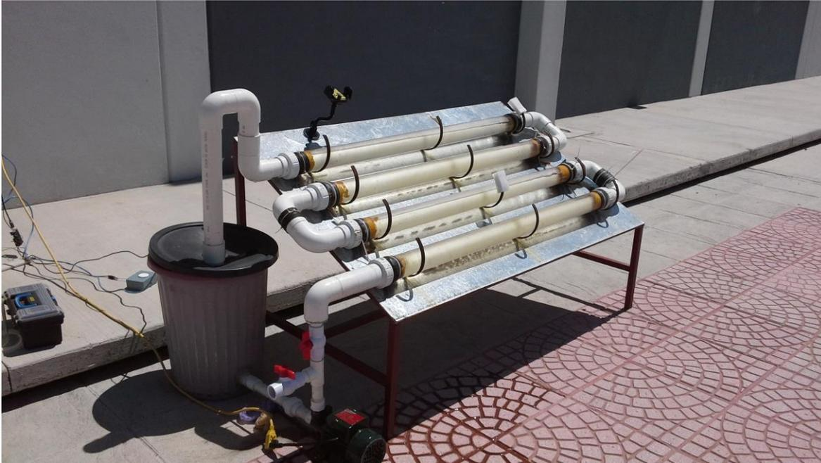
**Figura 33** Sistema con un reactor collector no concentrado (NCC) tipo Batch.
