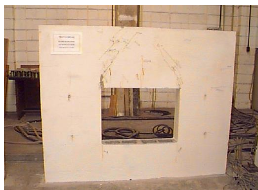
Figura 25. Agrietamiento de muro con abertura sin refuerzo (Lopes, 2001).
