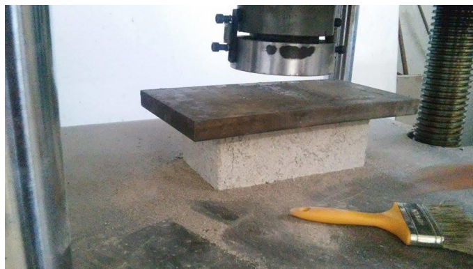
Figura 38. Ensayo a compresión en piezas de tabicón.
