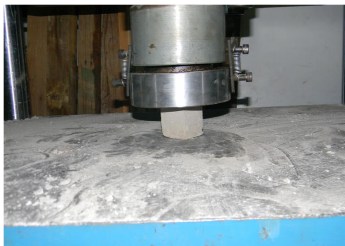
Figura 42. Ensayo de cubos de mortero (Jaen, 2015).
