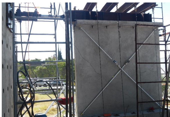
Figura 73. Ensaye de muro de tabicón reforzado.
