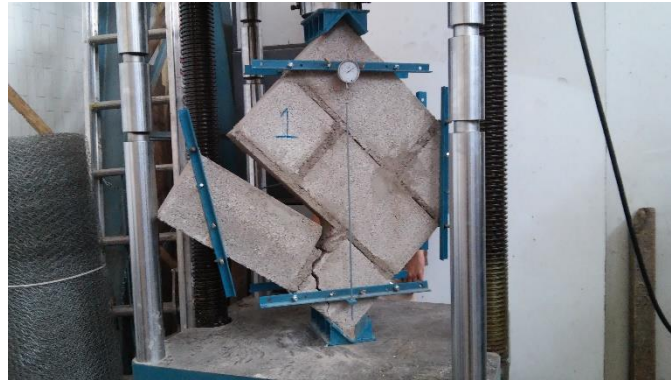
Figura 48. Ensayo de murete construido con piezas de block de concreto ligero.
