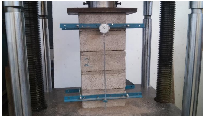
Figura 45. Ensaye de pila construida con piezas de tabicón.
