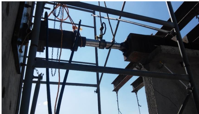
Figura 59. Aplicación de cargas horizontales.
