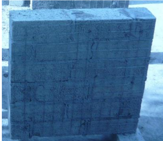
Figura 30. Murete reforzado con multimalla ferretera (Alonso y Mendoza, 2012).
