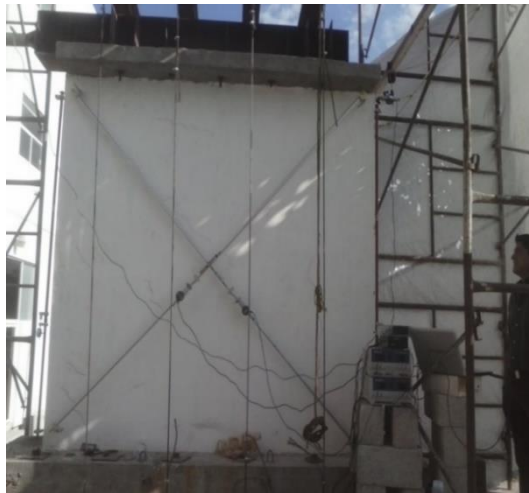
Figura 53. Instrumentación de los muros (Romero, 2015).
