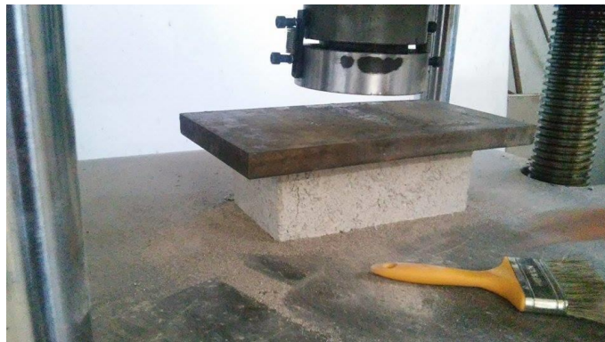
Figura 38. Ensayo a compresión en piezas de tabicón.
