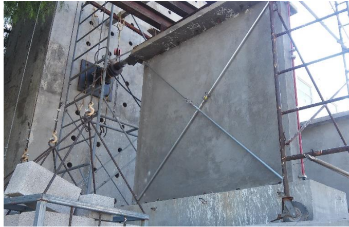
Figura 74. Ensaye de muro de block de concreto ligero reforzado.
