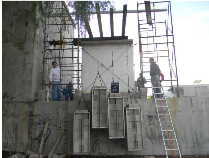
Figura 64. Prueba en muro testigo sin refuerzo construido con piezas de block de concreto ligero (Jaen, 2015).
