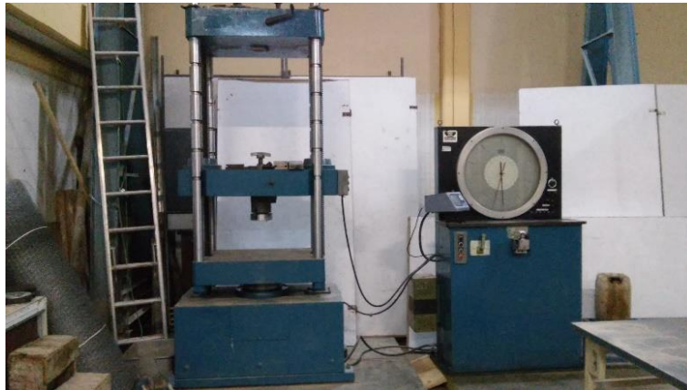
Figura 37. Máquina universal utilizada para las pruebas en piezas, pilas y muretes.
