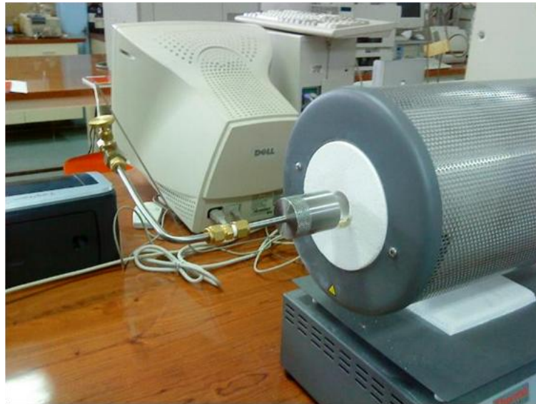
Figura 3.8 Equipo utilizado para calcinación de membrana impregnada con plata en horno tubular.
