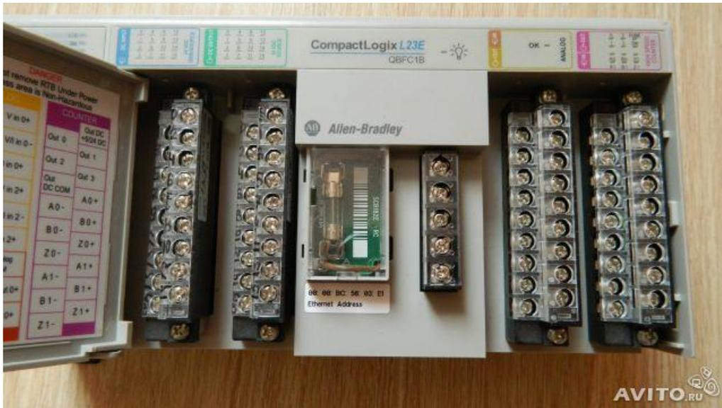
Figura 3.10. Controlador Lógico Programable PLC.
