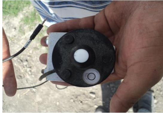
**Figura 2.5** Sensor de radiación PAR.
