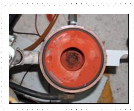
Figura 4.23. Arcilla sin fundir fuera del crisol, sistema de arco transferido.
