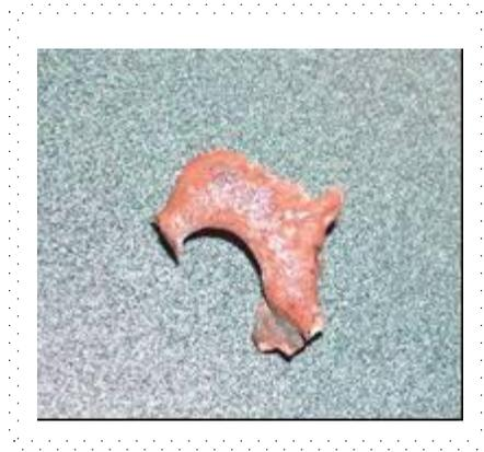
Figura 4.24. Arcilla 1 vitrificada en el sistema de arco transferido.
