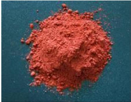
Figura 4.19. Arcilla Cerámica compuesta por  $\text{CaO}$ ,  $\text{Fe}_2\text{O}_3$ ,  $\text{Na}_2\text{O}$ ,  $\text{SiO}_2$ ,  $\text{Al}_2\text{O}_3$ ,  $\text{Ti}_2\text{O}$ ,  $\text{Co}_2\text{O}_3$ ,  $\text{ZnO}$ .
