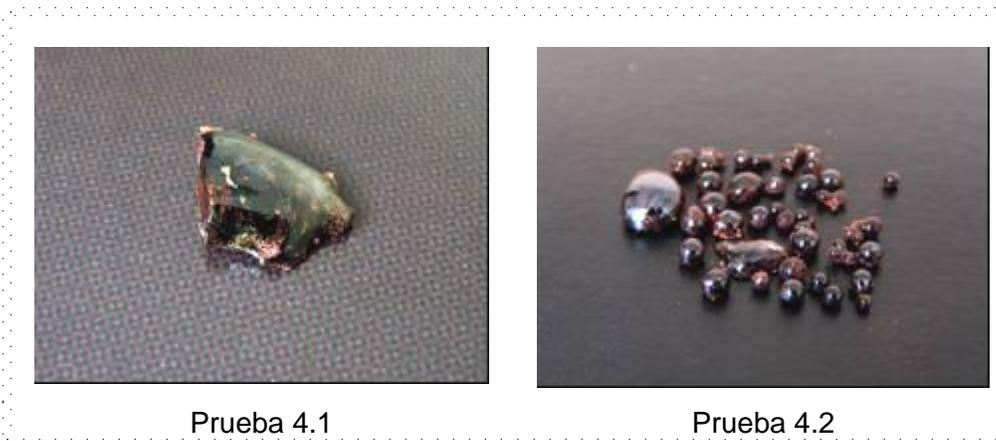
Figura 4.26 Material vitrificado con arco transferido a presión atmosférica, pruebas 4.1 y 4.2.
