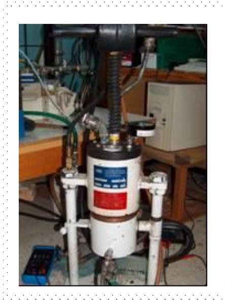
Figura 3.7. Sistema de Arco transferido con vacío, Laboratorio de aplicaciones de Plasma Térmico.
