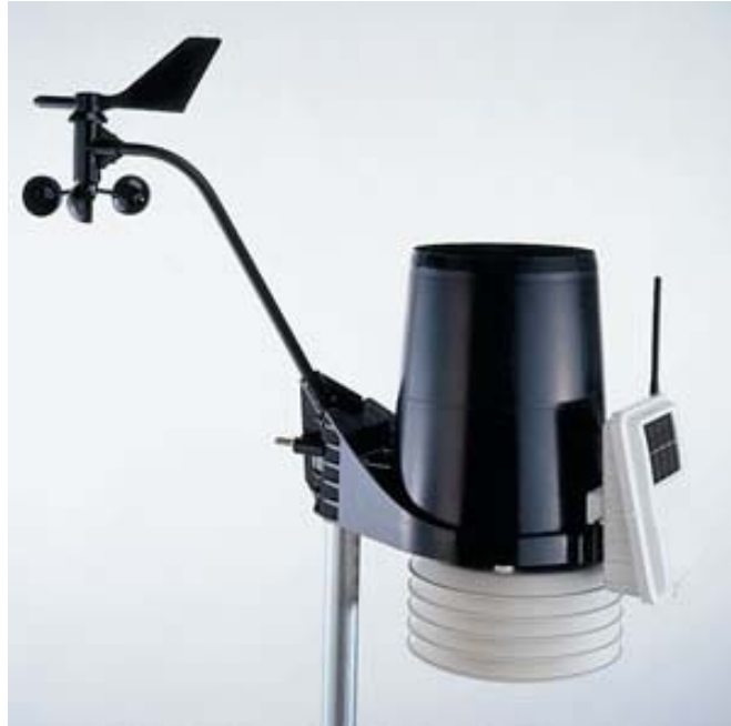
Figura 3.1. Estación meteorológica Davis®, que transmite datos climatológicos en tiempo real, con intervalos de 10 minutos.
