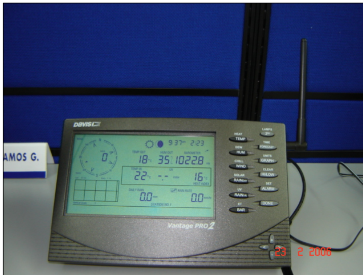
Figura 3.2. Consola de captura y transmisión de datos que se obtienen (en tiempo real) mediante los sensores instalados en la estación meteorológica Davis®.
