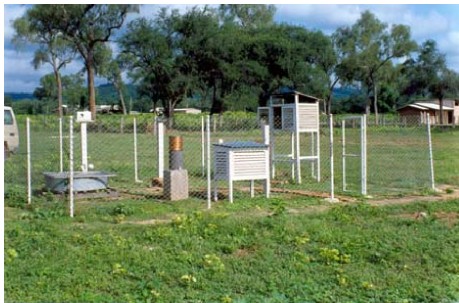
Figura 3.3. Estación meteorológica tradicional situada para zonas abiertas.
