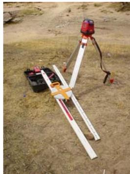
**Foto 1.-** Nivel láser con el que se midieron los perfiles del río.
