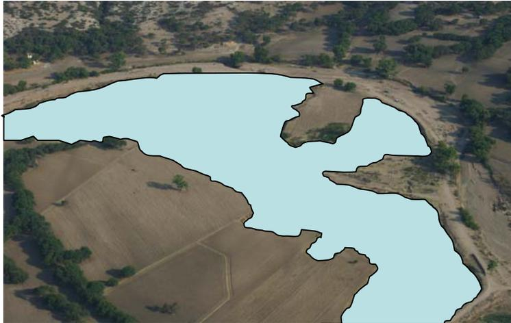
**Figura 9.-** Zona impactada por la extracción de materiales pétreos (grava y arena)
