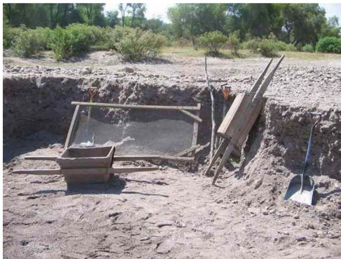
**Foto 16.-** Herramienta de trabajo de los paleros. Se puede apreciar el harnero, parigüela, pala y pico.
