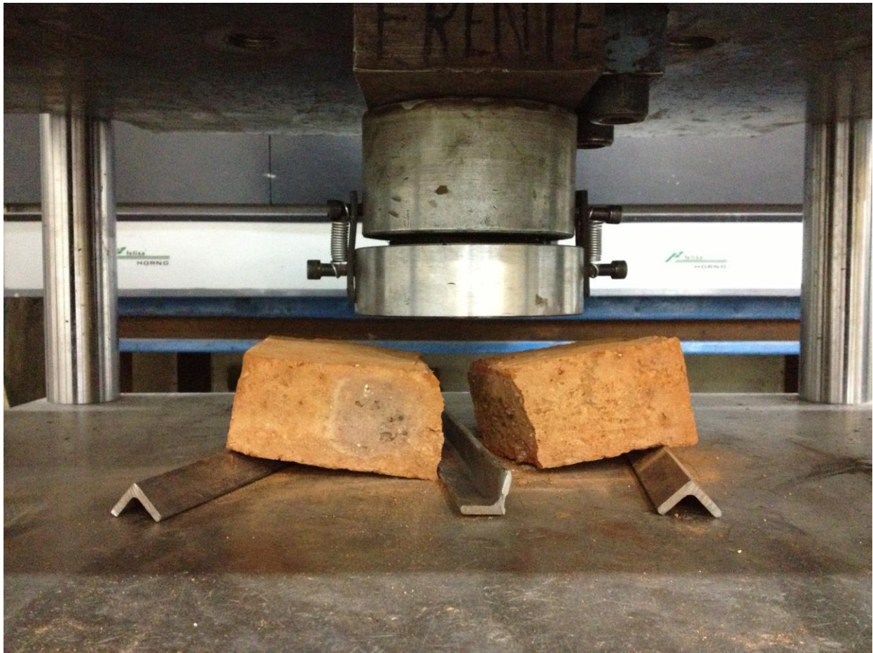
Figura 4.3 Pieza ensayada, donde se muestra la falla originada por flexión
