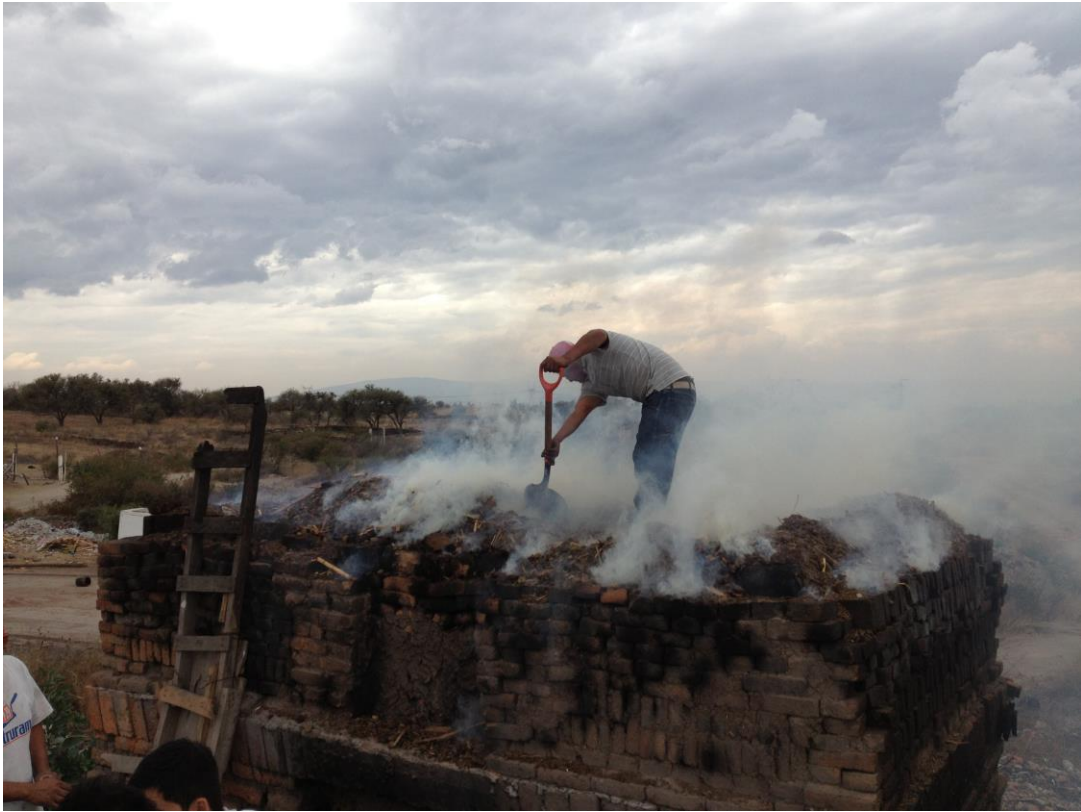
Figura 3.25 Aplicación de mezcla de estiércol y aserrín a parte superior de horno para conservar la alta temperatura
