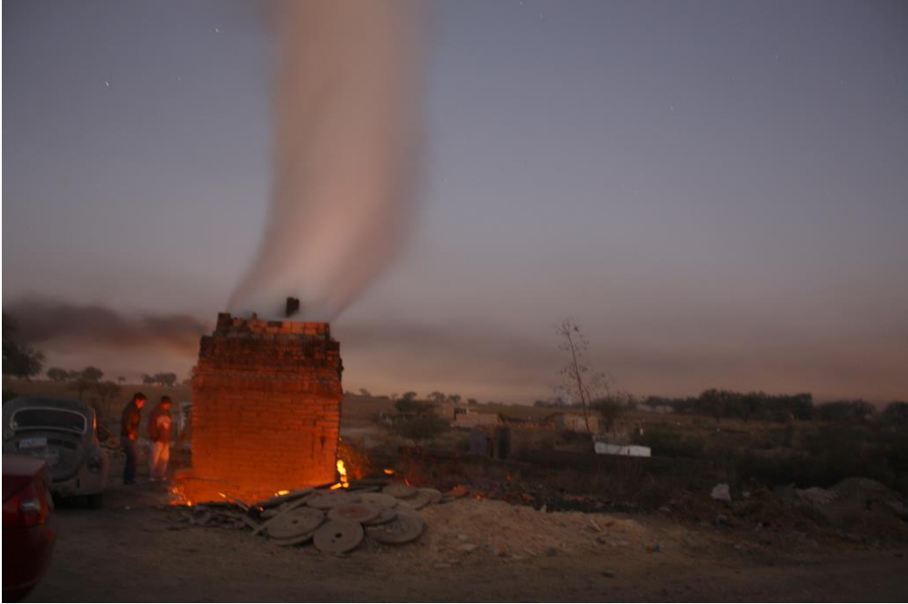
Figura 3.25 Aplicación de mezcla de estiércol y aserrín a parte superior de horno para conservar la alta temperatura
