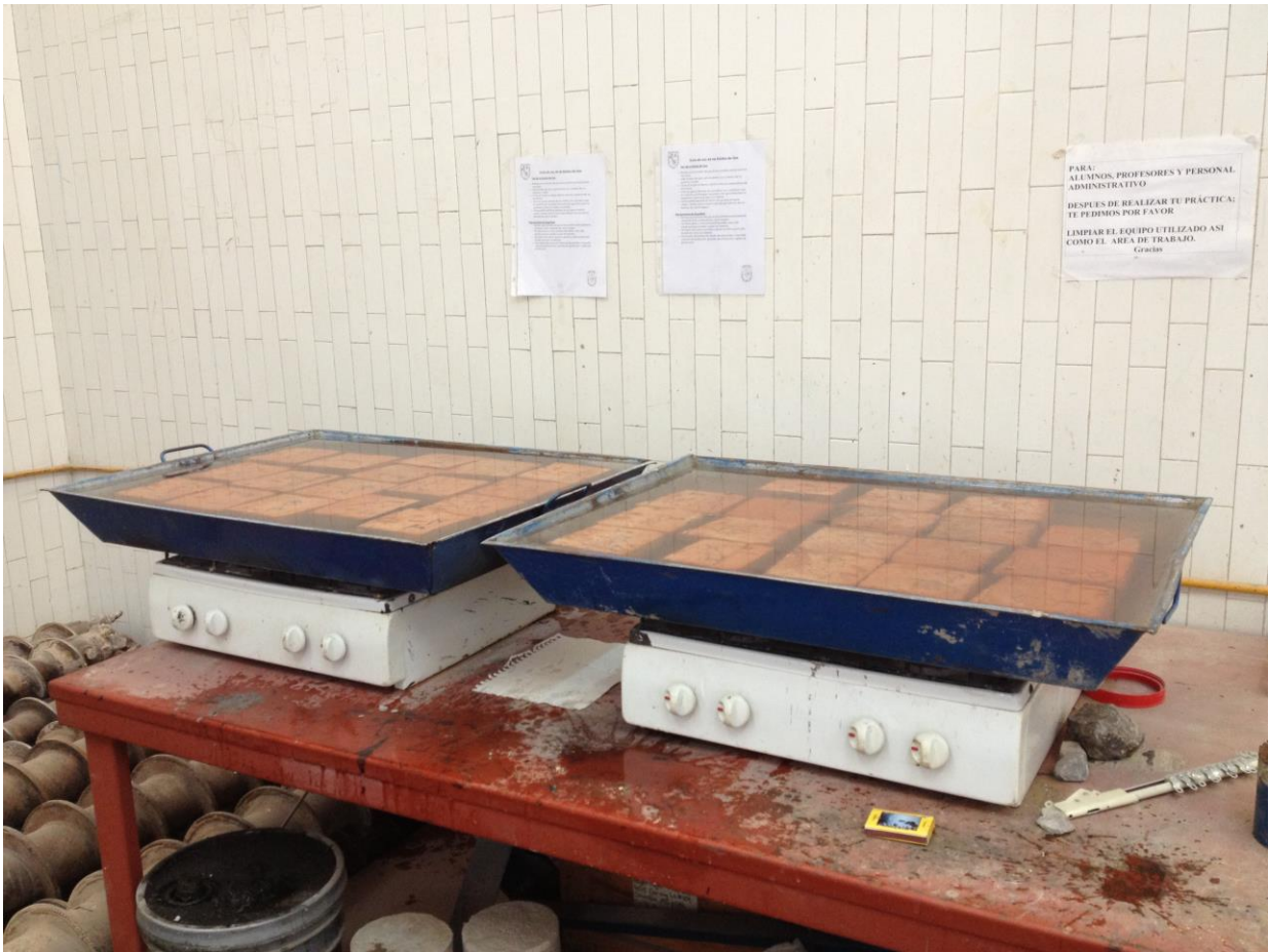
Figura 4.10 Piezas colocadas a ebullición durante 5 horas.
