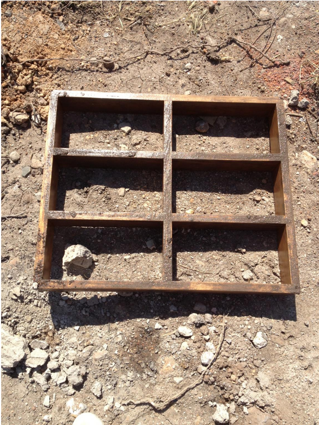
Figura 3.19 Molde utilizado por el fabricante para la elaboración del tabique fresco
