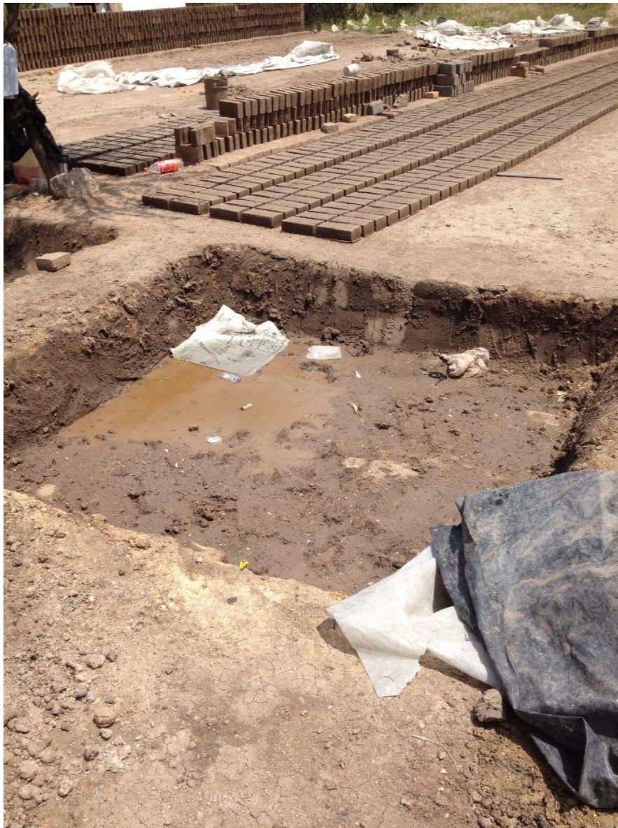
Figura 3.2 Lugar de donde obtienen la mezcla para la realización de los tabiques
