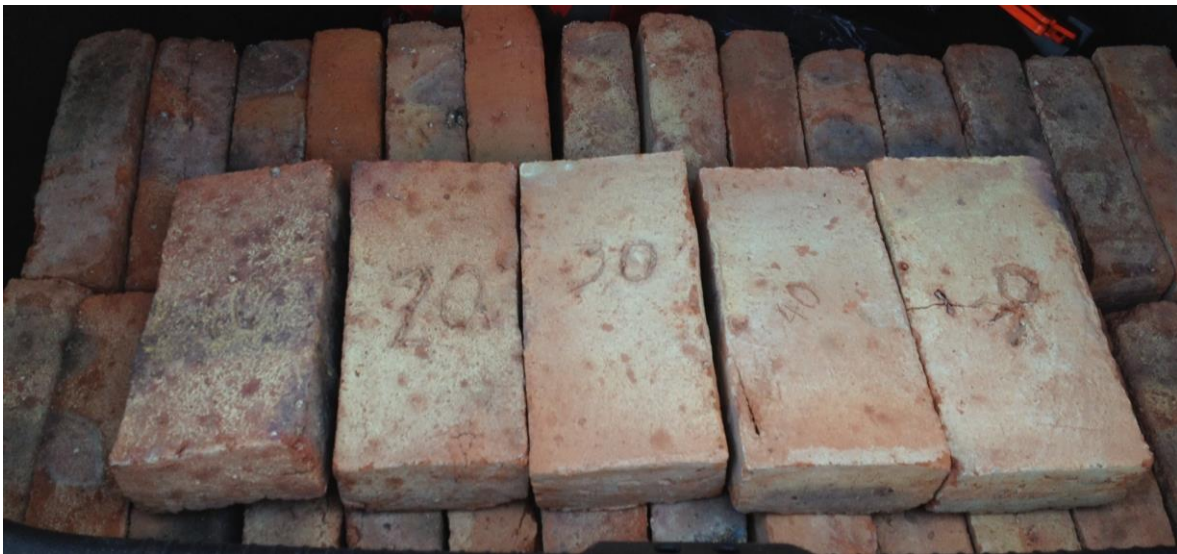
Figura 3.27 Tabiques recién salidos del horno
