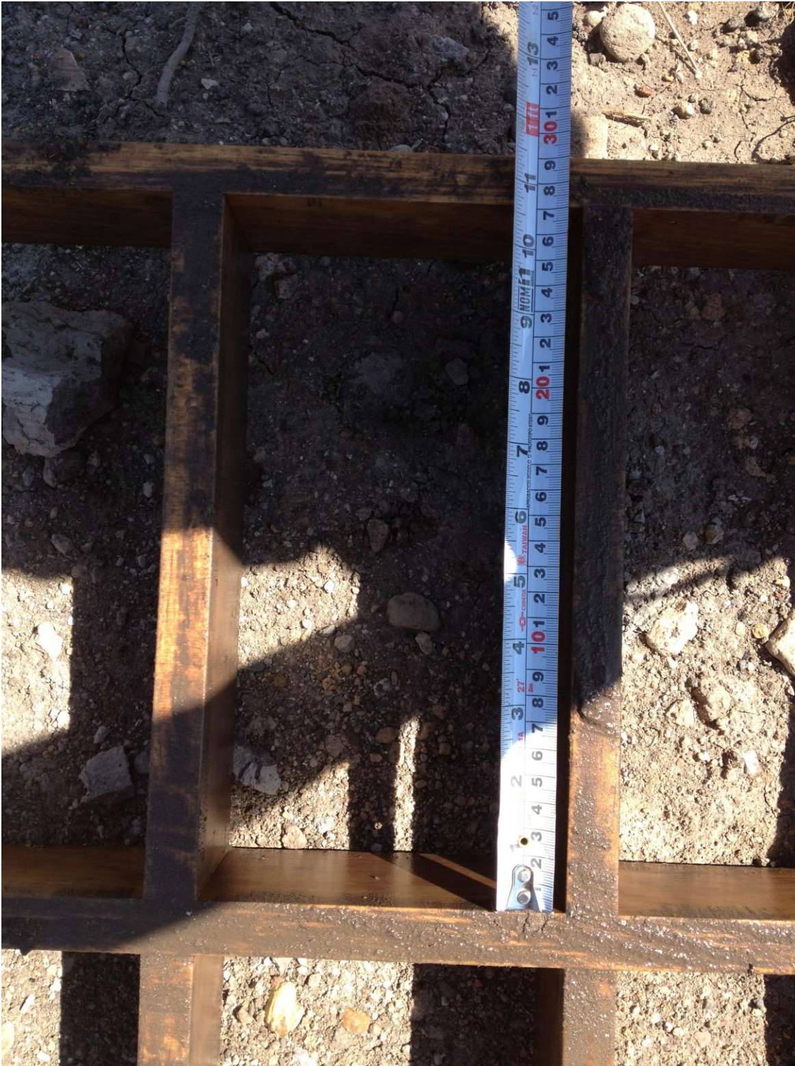
Figura 3.15 Demostración de largo de molde para tabique igual a 27 cm
