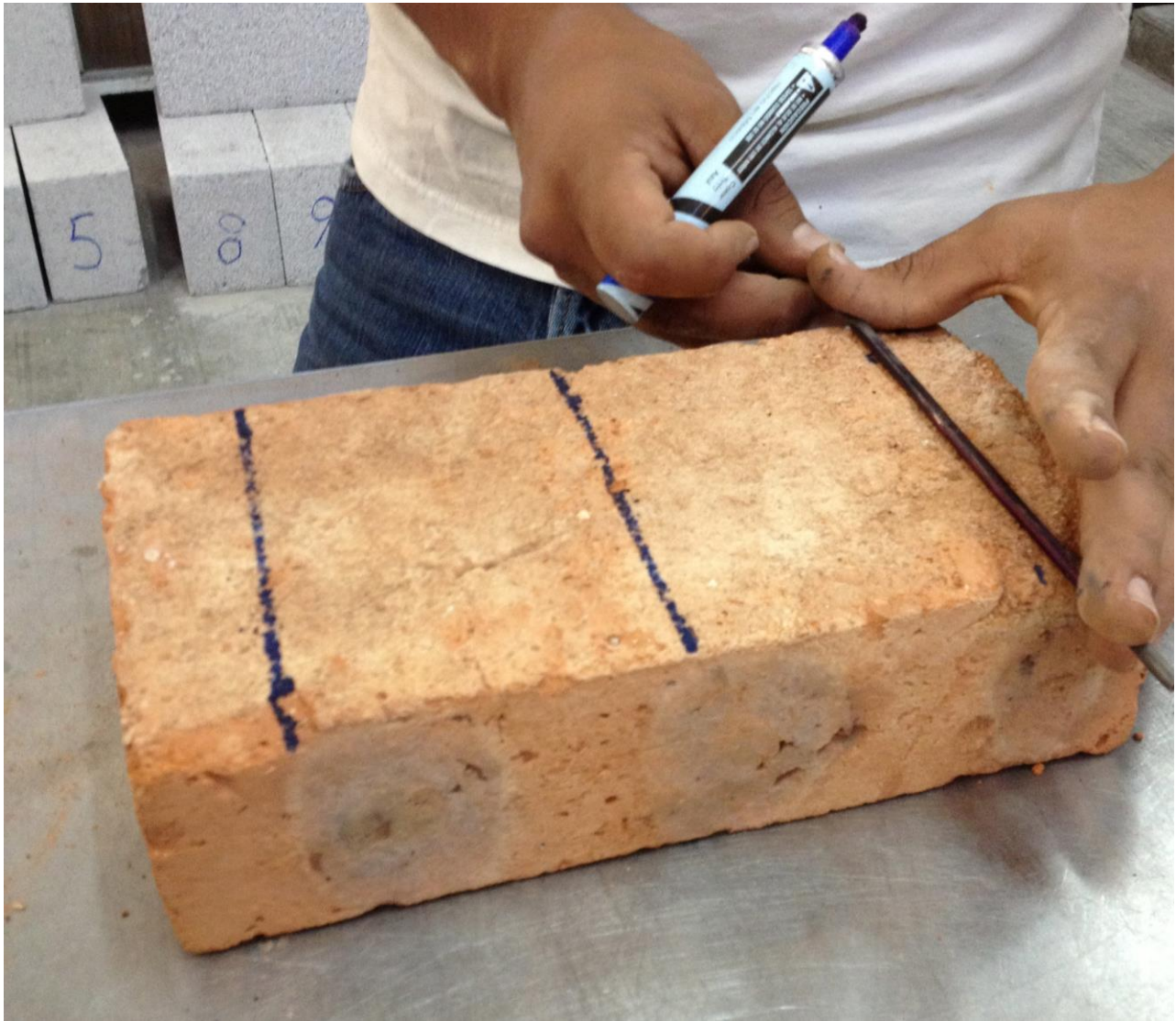
Figura 4.1 Medición y determinación de puntos de apoyo para prueba
