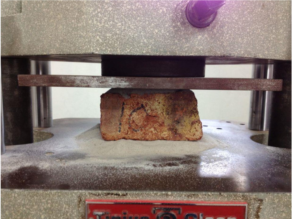
Figura 4.12 Representación de prueba a compresión simple
