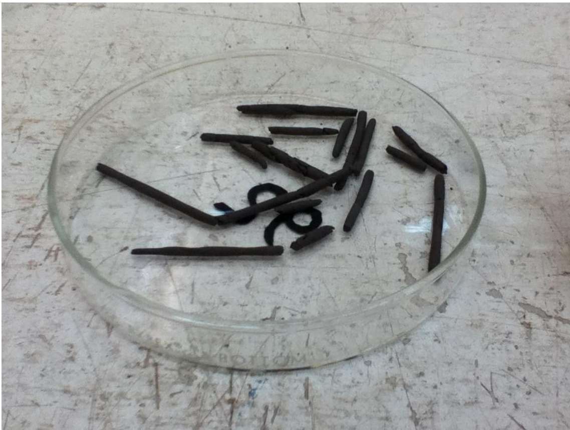
Figura 3.11 Rollitos de suelo con grosor de 3.2 mm aproximadamente para determinar el Límite Plástico.
