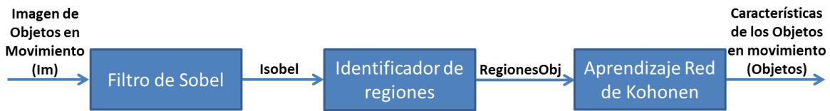
Figura 2-8 Diagrama del extractor de características de Ferraz y Lameda (2008)©.
