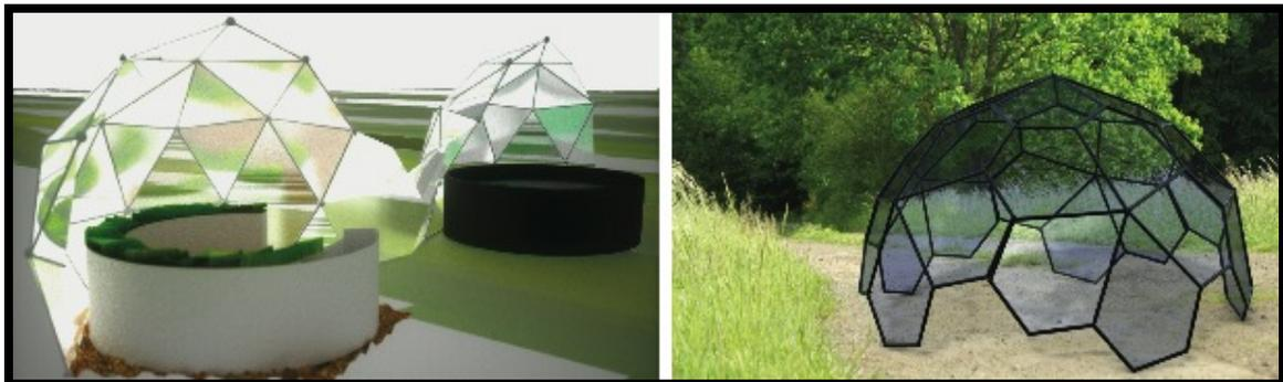
**Figura 12. Modelos rápidos, de izquierda a derecha, se muestra un concepto de invernadero dividido, donde el sistema acuapónico se encontraba separado de los cultivos para mantener diferentes índices de humedad relativa; mini-invernadero hexacontaedral.**
