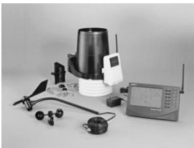
Figura 4.5. Estación meteorológica Wireless Vantage Pro2 modelo 6152 marca DAVIS.
