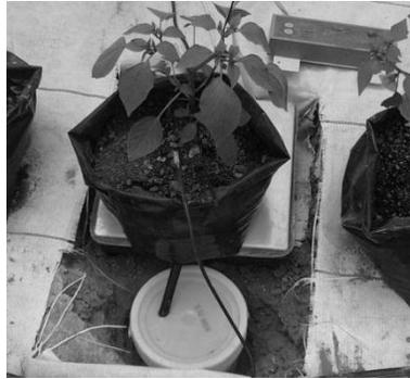
Figura 4.14.- Drenaje instalado en el lisímetro de pesada.
