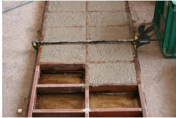
**Figura 44.** Vaciado de la pasta, primera parte (foto tomada en la UAQ)
