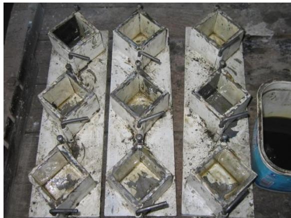
**Figura 20.** Moldes cúbicos de 5 cm por lado engrasados (foto tomada en la UAQ)
