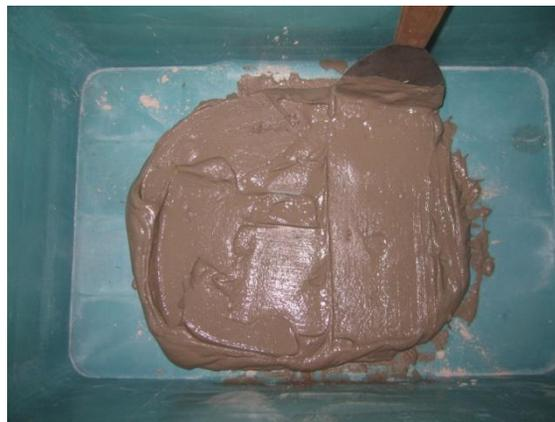
**Figura 24.** Mesclado del cemento y el agua (foto tomada en la UAQ)
