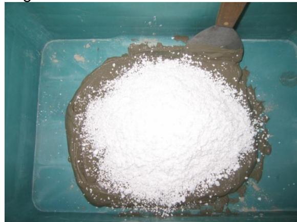
**Figura 32.** Poliestireno agregado a la pasta (foto tomada en la UAQ)
