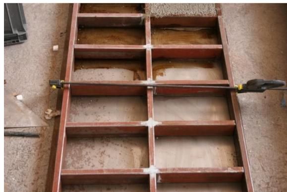
**Figura 37.** Moldes cúbicos de 5 cm por lado engrasados (foto tomada en la UAQ)
