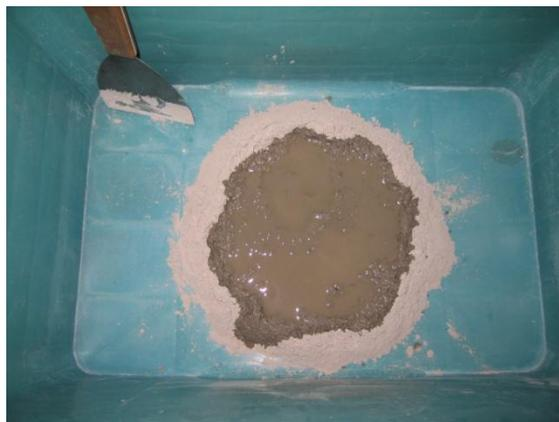
**Figura 23.** Charola con el cemento y agua (foto tomada en la UAQ)
