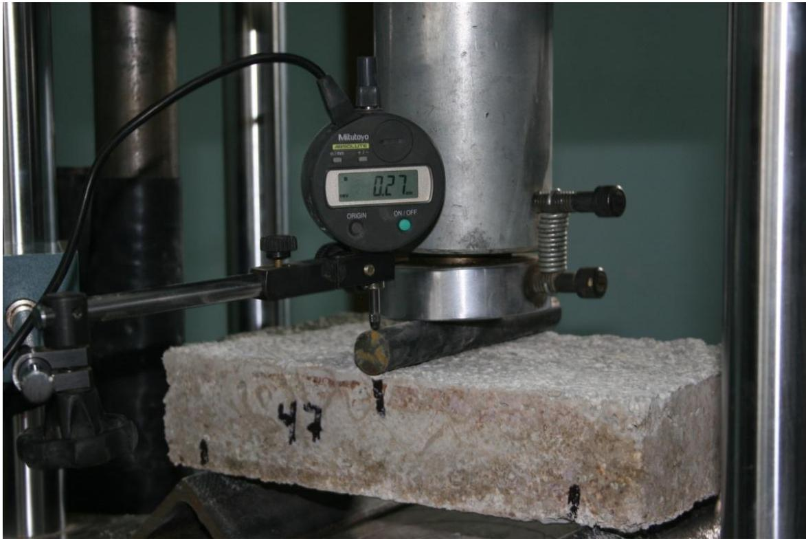
**Figura 48.** Prueba resistencia a flexión (foto tomada en la UAQ)
