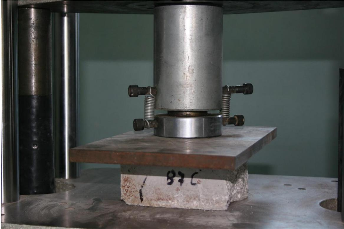
**Figura 49.** Prueba resistencia a compresión (foto tomada en la UAQ)
