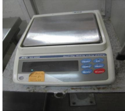
**Figura 35.** Báscula digital, utilizada para pesar el poliestireno (foto tomada en la UAQ)
