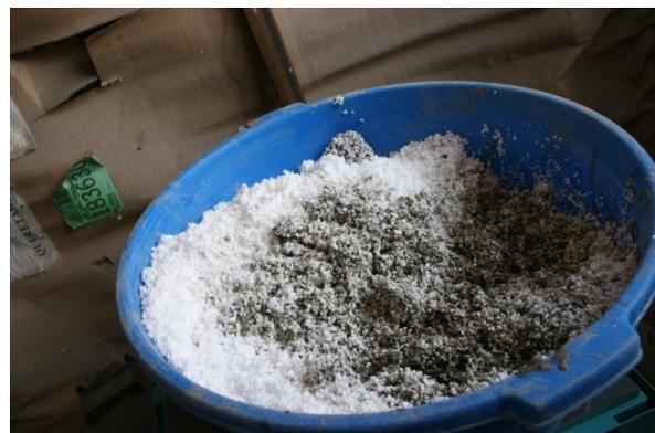
**Figura 43.** Mezcla de las pasta con el poliestireno (foto tomada en la UAQ)
