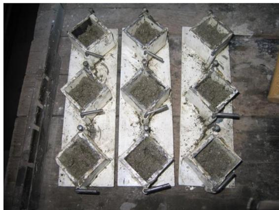
**Figura 25.** Vaciado de la pasta, primera parte (foto tomada en la UAQ)
