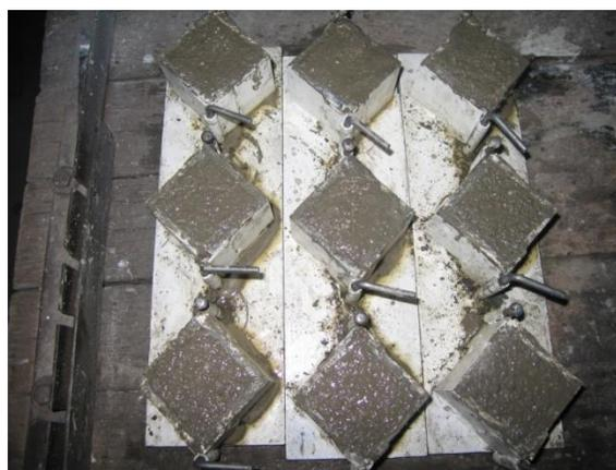
**Figura 26.** Vaciado de la pasta, segunda parte (foto tomada en la UAQ)
