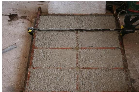
**Figura 45.** Vaciado de la pasta, segunda parte (foto tomada en la UAQ)
