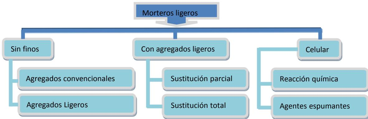
**Figura 2.** Clasificación de los morteros ligeros en función de la forma de introducir aire en su estructura. (Organista, 1999, p.2-2)
