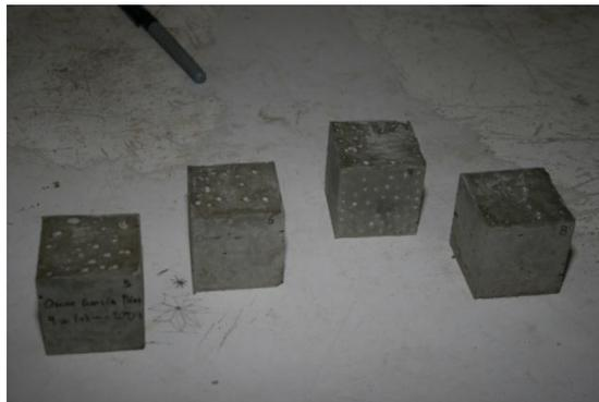
**Figura 27.** Descimbrado de moldes (foto tomada en la UAQ)
