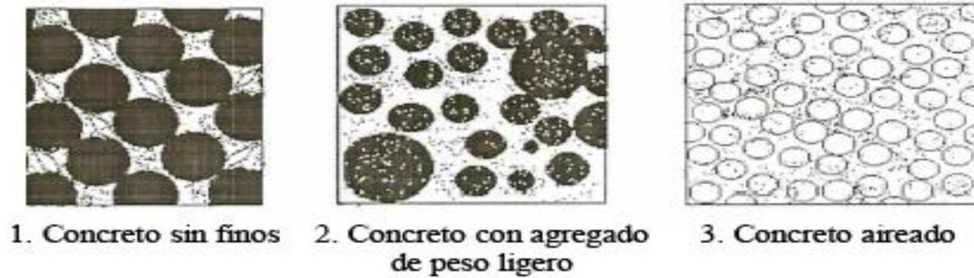
**Figura 7.** Vista microscópica de las partículas de diferentes tipos de concreto ligero (Concretos Celulares, Ltda., 2004).
