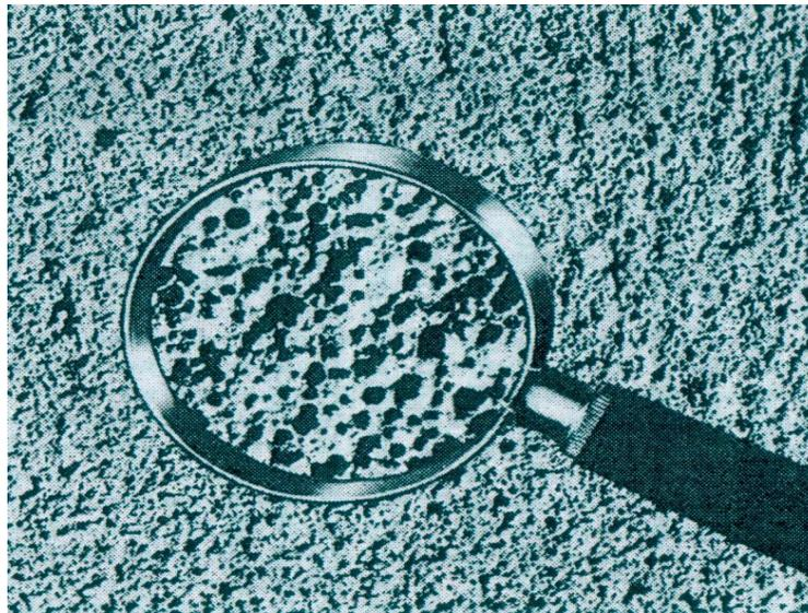
**Figura 10.** Cavidades del mortero celular originadas por burbujas de aire (The Aberdeen Group, 1963)
