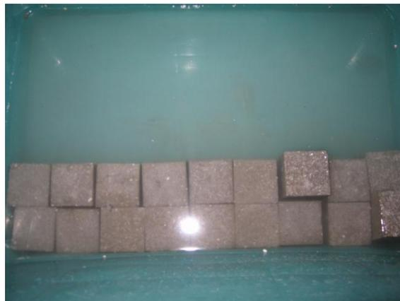
**Figura 28.** Curado de especímenes (foto tomada en la UAQ)
