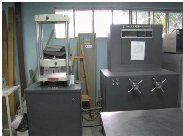
**Figura 30.** Máquina Universal Tinius Olsen (foto tomada en la UAQ)
