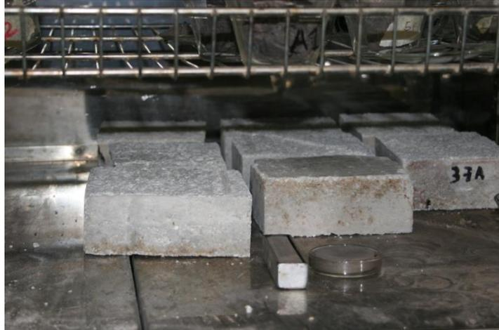
**Figura 59.** Bloque en horno a 110°C.
