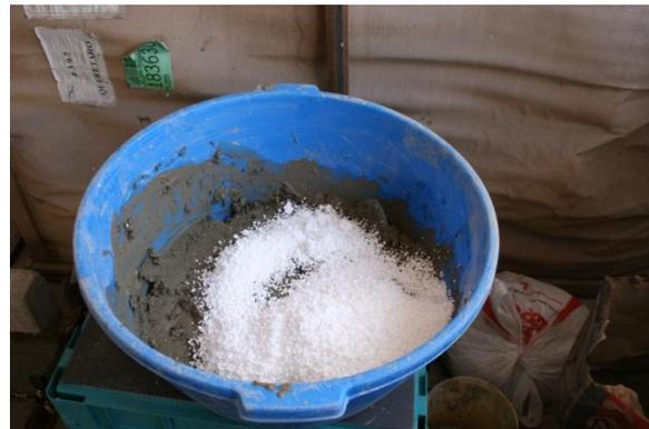
**Figura 42.** Poliestireno agregado a la pasta (foto tomada en la UAQ)
