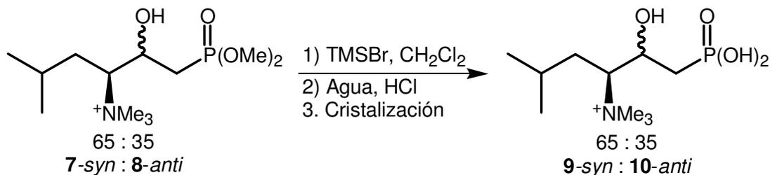
**Figura 20. Preparación del ácido aminohidroxifosfónico **9-syn**:**10-anti**** la mezcla de trimetilamino  $\beta$ -hidroxifosfonato **7-syn**/**8-anti** fue puesta a reaccionar con TMSBr en cloruro de metileno, el producto obtenido fue lavado exhaustivamente con acetato de etilo y cristalizado para poder obtener la mezcla de ácidos aminofosfónicos **9-syn**: **10-anti** los cuales son compuestos análogos fosforados de *L*-carnitina.
