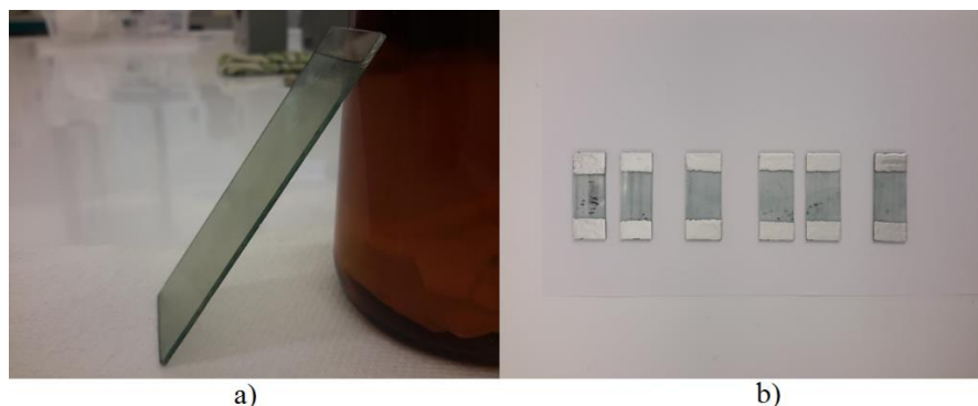
Figura 70. a) Película de PANI ES depositada sobre un sustrato de vidrio. b) Corte de muestras de 1 cm de ancho por 2.5 cm de largo y preparación de contactos con pintura de plata.
