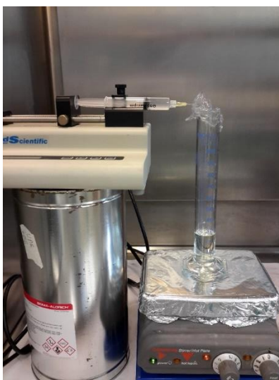
Figura 54. Reactor discontinuo de polimerización oxidativa.
