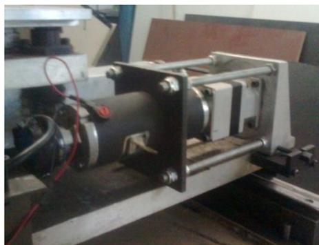
Figura 3.11. Montaje del motor SSC 23SMDC-LCSS en el eje Y.
