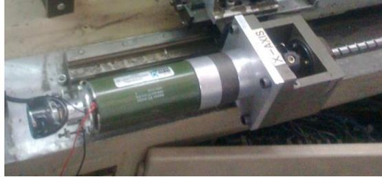
Figura 3.12. Montaje del motor Maxon 2260.885-73.216-200 en el eje X.
