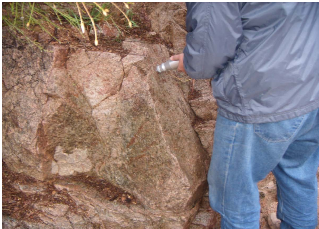
Foto 5.7. Prueba de resistencia in situ del material rocoso, además de recolección de muestras para su ensaye en laboratorio.
