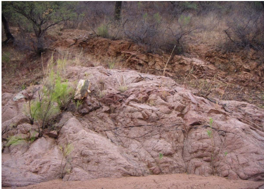
Foto 5.5. Afloramiento rocoso de color claro que servirán de empotramiento, la banda de fracturamiento es notoria.
