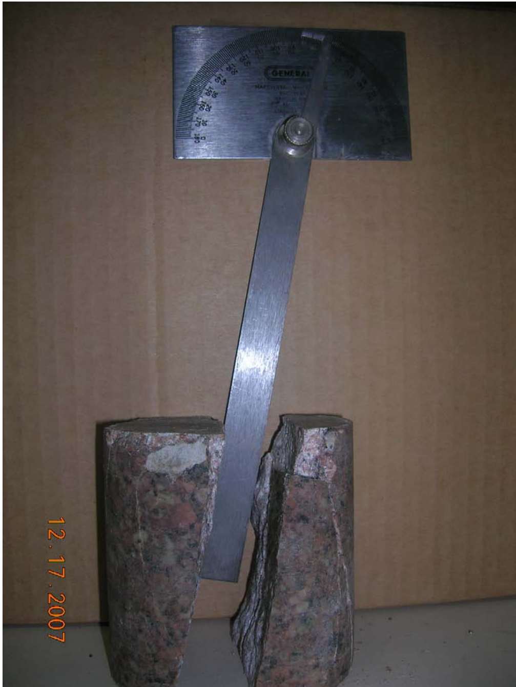
Figura 4.6. Fracturamiento de la roca granodiorita. Ángulo de falla = 45^\circ - \frac{1}{2}\phi .
