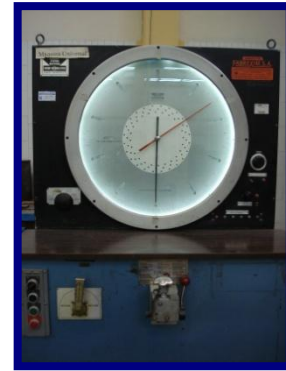
c. Dispositivo de caratula para la lectura de la carga.
