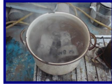
Figura 3.43 Muestras sometido a hervido.
