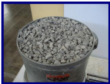
Figura 3.11 Recipiente volumétrico de 10 l para determinar el peso volumétrico seco y compacto del agregado grueso.
