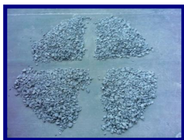
Figura 3.5 Cuarteo de material grueso.
