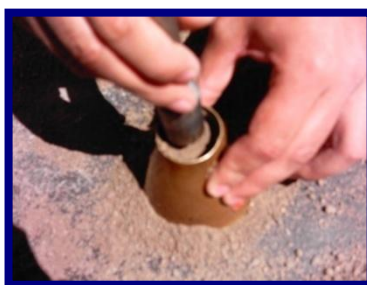
b. Compactación del material.
