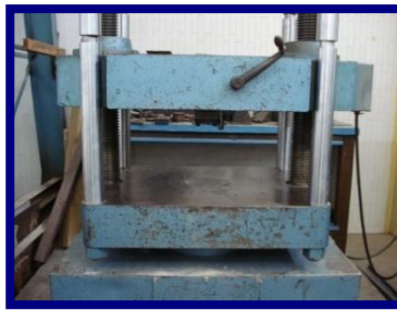
b. Bloques de acero para la aplicación de la carga.
