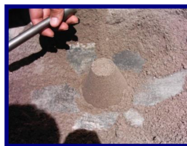
c. Material con agua en exceso.
