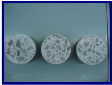
a. Muestras de concreto después del corte.
