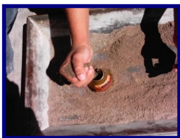
a. Llenado del molde troncocónico.
