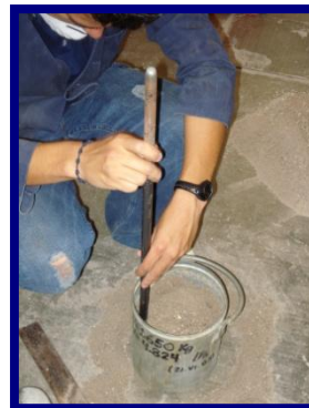
Figura 3.25 Compactación del material fino para determinar el peso volumétrico seco y compacto.
