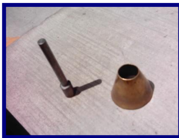
Figura 3.21 Molde troncocónico de bronce y pisón.
