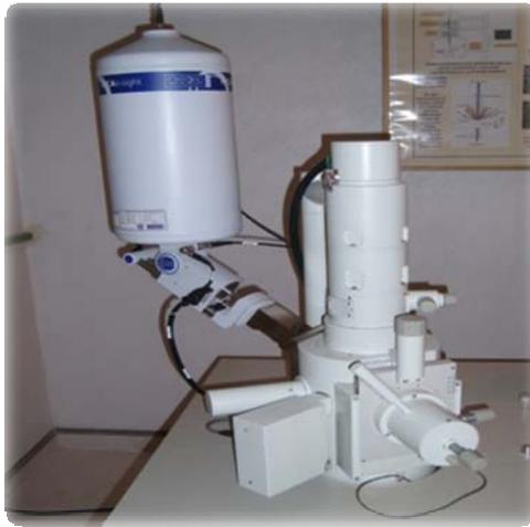
Figura 3.16 Microscopio Electrónico de Barrido.
