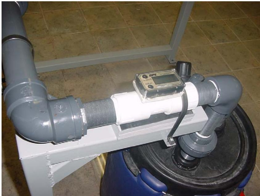
Figura 3.4 Medidor de flujo GPI
