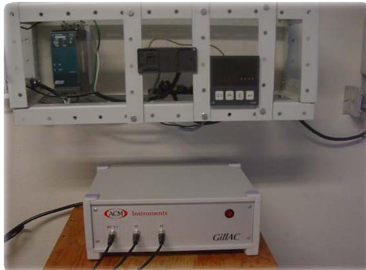
Figura 3.15 Potenciostato con el que se mide el ruido electroquímico en el sistema de pruebas (reactor loop).
