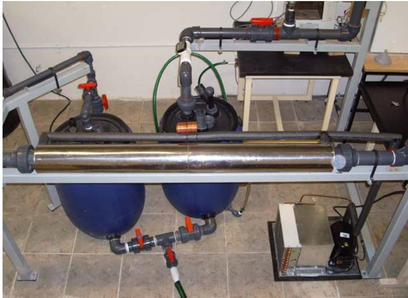
Figura 3.7 Sistema de enfriamiento del Reactor Loop
