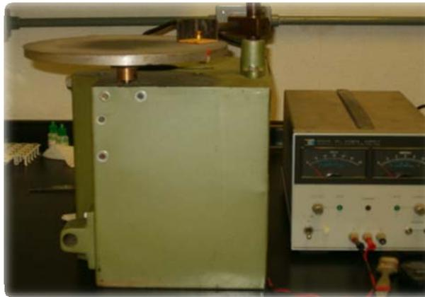
Figura 3.17 Equipo de pruebas de abrasión
