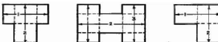
Fig. 2.3. Diseño típico de rectángulos para losas de forma irregular.
