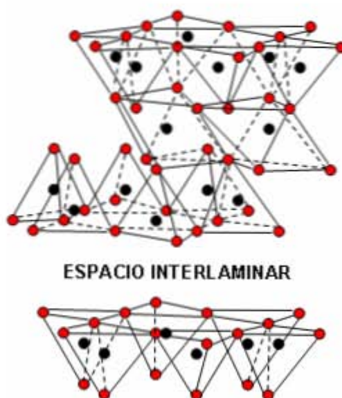
Fig.1.1. Esquema representativo del mineral montmorilonita.
