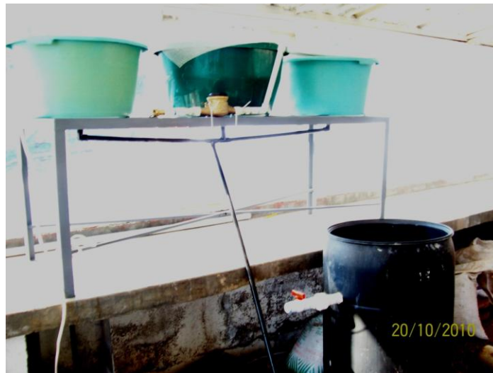
Figura 4.7 Diseño definitivo de sedimentador con capacidad de 160 litros.
