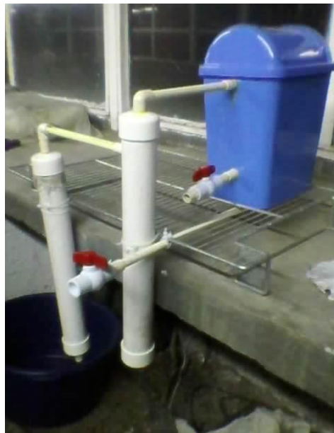
Figura 4.3 Filtro de antracita para quitar carbón y eliminar sabor y olor.
