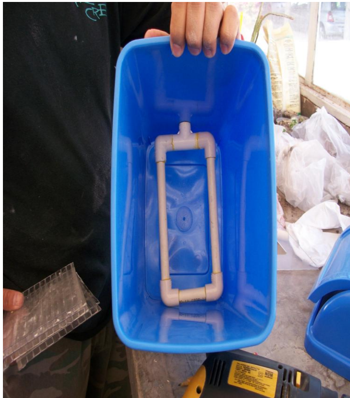
Figura 4.1 Construcción del primer prototipo con capacidad de 10 litros.
