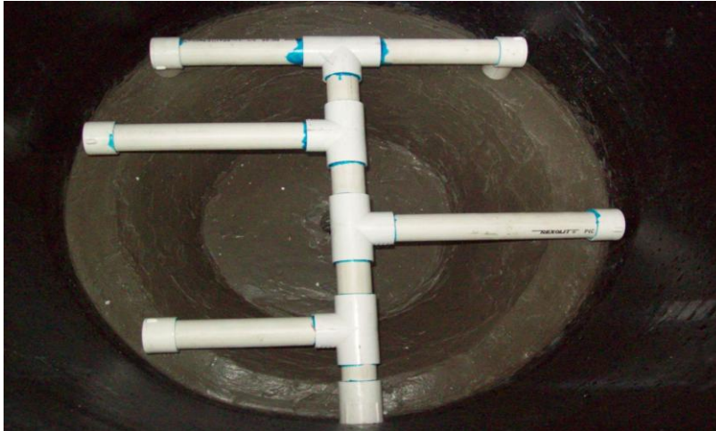
Figura 4.5 Fondo cónico con un ángulo de inclinación de 60 °.
